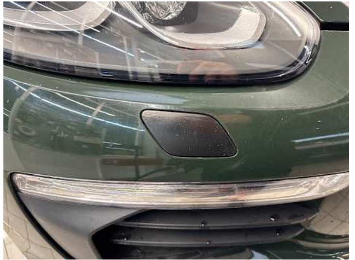
Stoßstange vorne (Unsachgemäß instand gesetzt)
