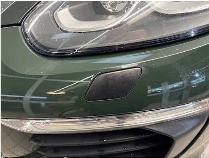
Stoßstange vorne (Unsachgemäß instand gesetzt)
