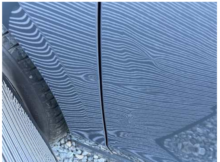
Kotflügel vorne links (Verformung)
