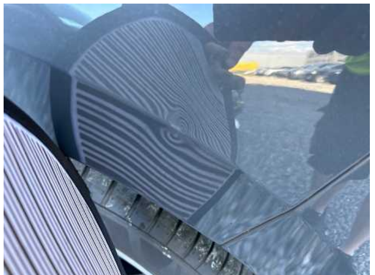
Seitenteil hinten links (Kratzer, Verformung)
