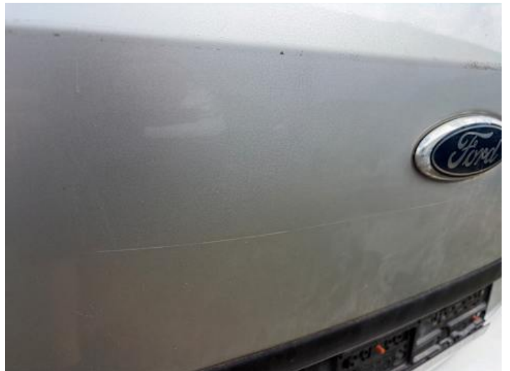
Heckklappe (Lackschaden, Kratzer)
