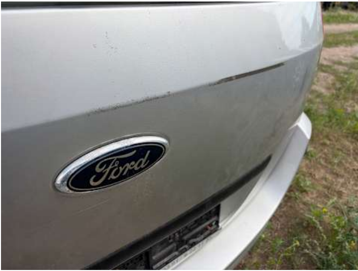
Heckklappe (Lackschaden, Kratzer)
