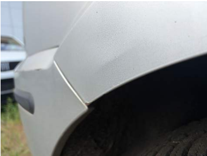
Seitenteil hinten rechts (Rost, Lackschaden, Delle)
