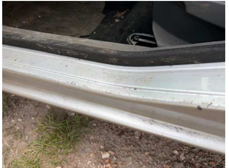
Schweller links (Lackschaden)
