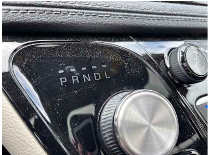
Innenraum (Anderer Schaden): Gang Anzeige ohne Funktion
