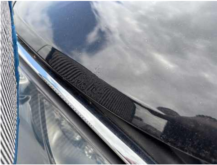
Motorhaube (Lackschaden, Rost)
