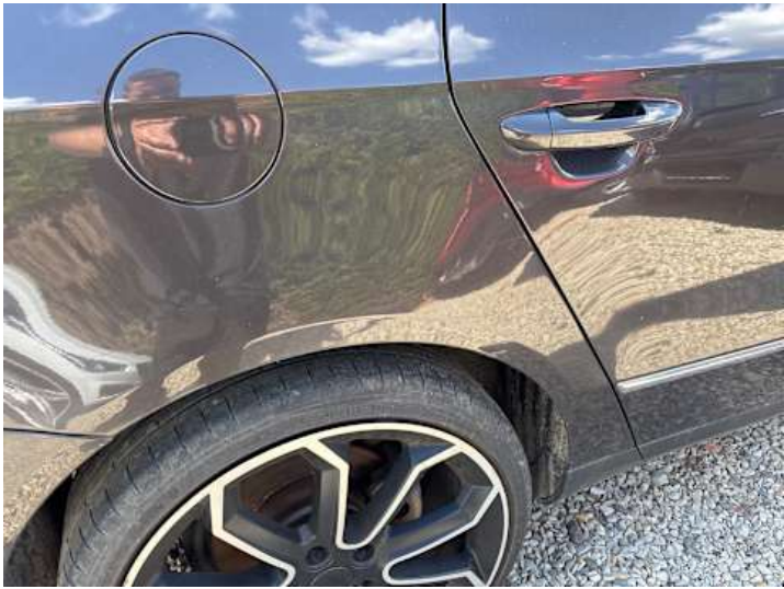
Seitenteil hinten rechts (Kratzer, Delle)
