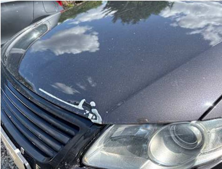
Motorhaube (Lackschaden, Delle, Kratzer)
