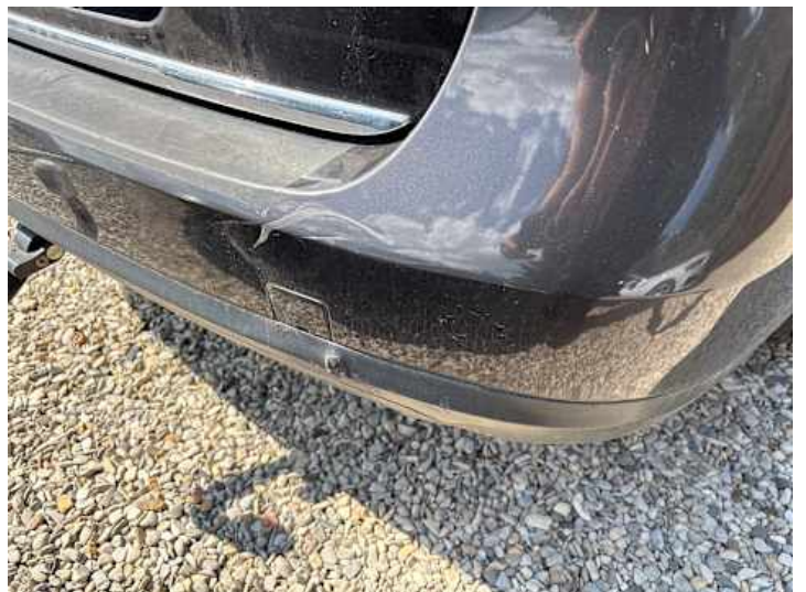
Stoßstange hinten (Kratzer, Lackschaden, Riss/Bruch)
