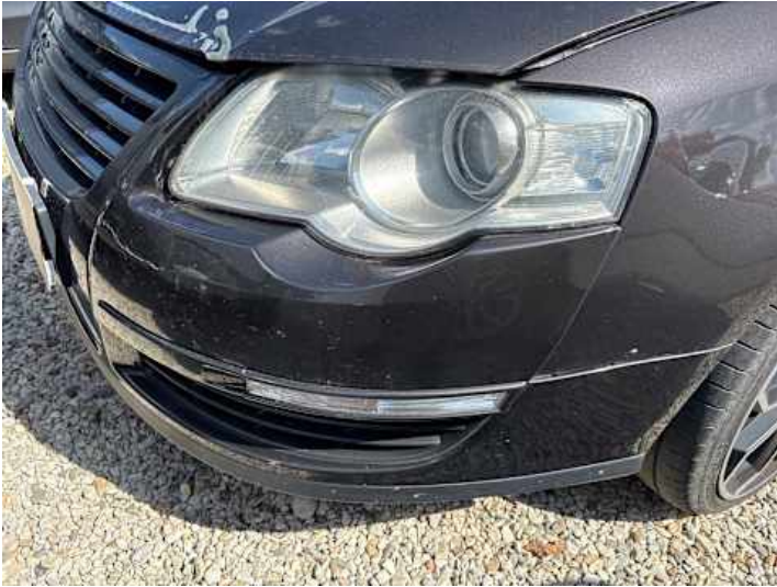
Stoßstange vorne (Spaltmaße ungenau, Riss/Bruch)
