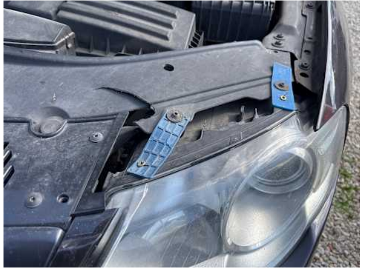
Scheinwerfer (links) (Anderer Schaden): Halterung nicht original Scheinwerfer wackelt
