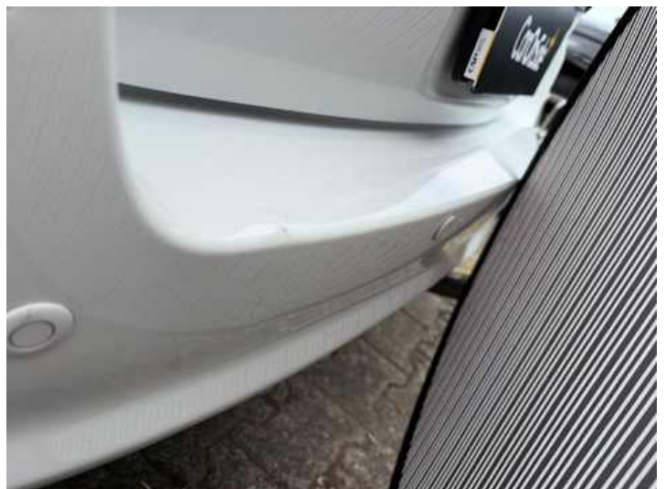
Stoßstange hinten (Verformung, Riss/Bruch)
