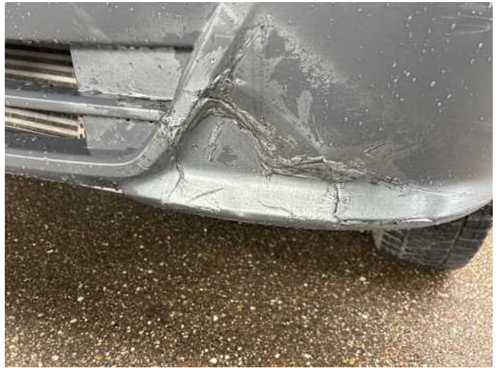
Stoßstange vorne (Delle, Kratzer)
