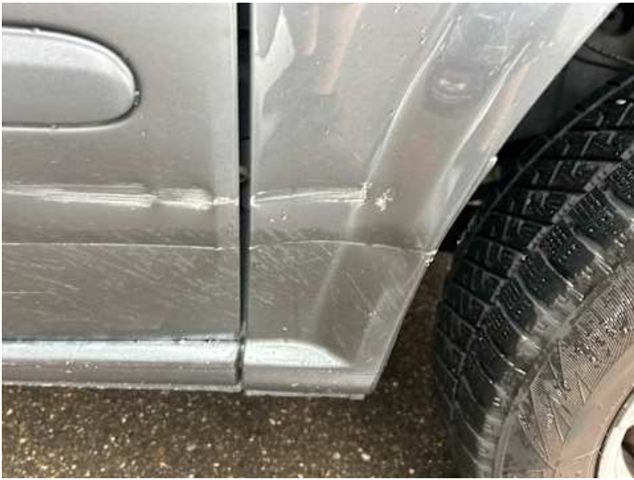
Kotflügel vorne rechts (Delle, Kratzer)
