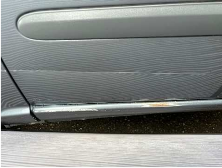
Fahrtür (Delle, Kratzer)
