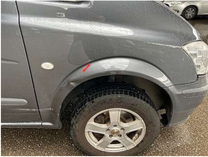
Kotflügel vorne rechts (Delle, Kratzer)
