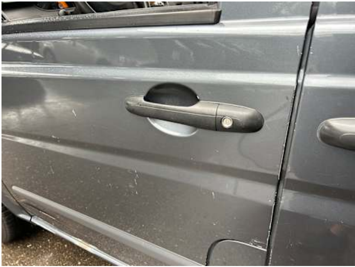
Fahrtür (Delle, Kratzer)
