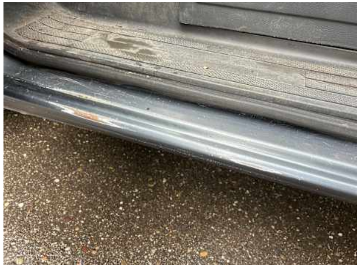
Schweller links (Kratzer)
