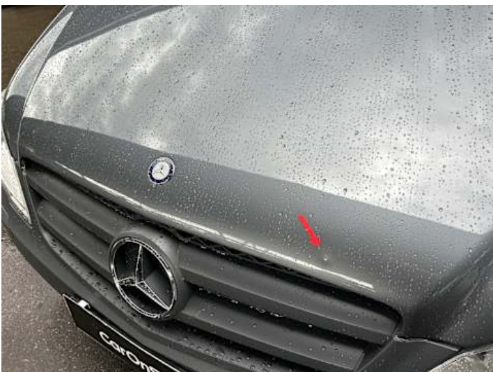
Motorhaube (Delle, Steinschlag)
