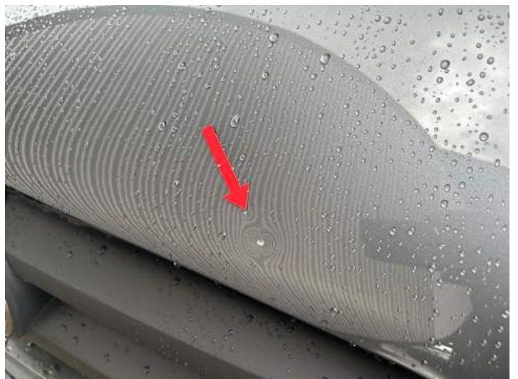
Motorhaube (Delle, Steinschlag)
