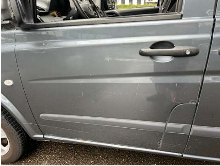
Fahrtür (Delle, Kratzer)
