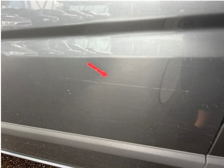
Türe hinten links (Kratzer)
