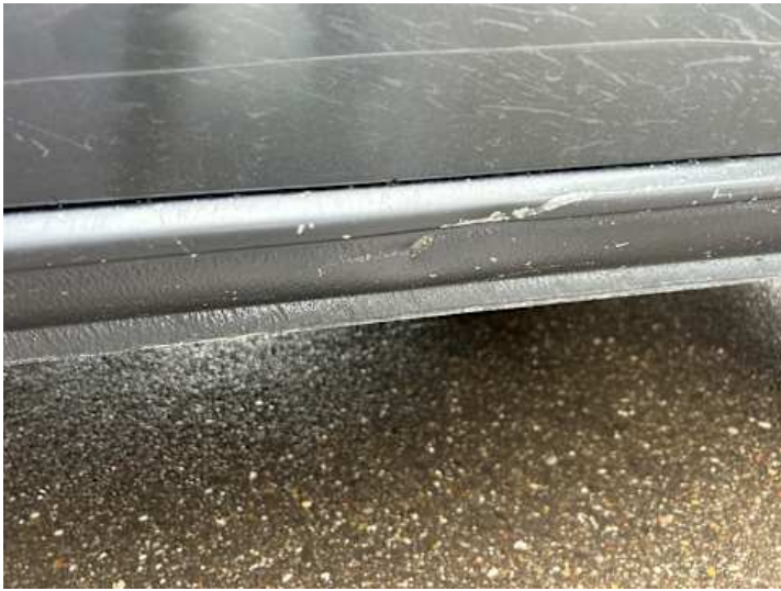
Schweller rechts (Kratzer, Delle)
