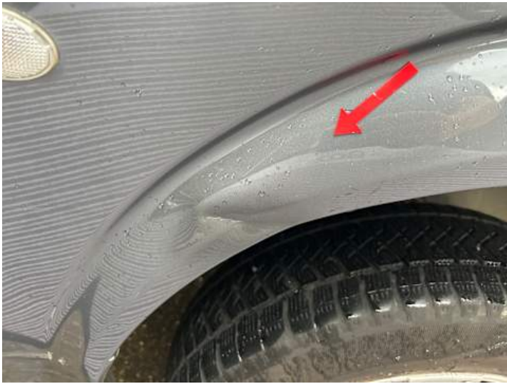
Kotflügel vorne rechts (Delle, Kratzer)
