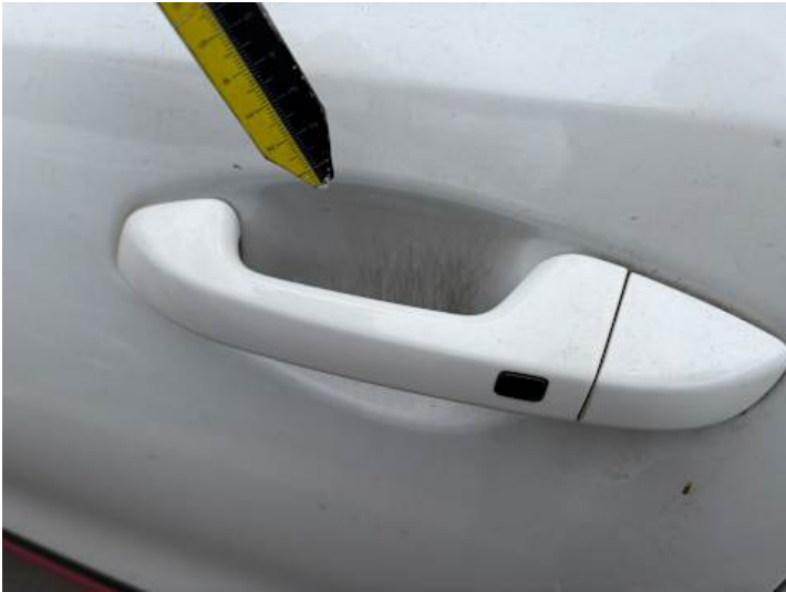
Fahrtür (Lackschaden, Kratzer)
