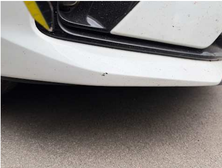
Stoßstange vorne (Lackschaden, Kratzer)
