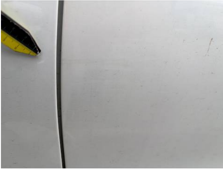
Türe hinten links (Lackschaden, Kratzer)
