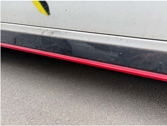
Schweller links (Lackschaden, Kratzer)
