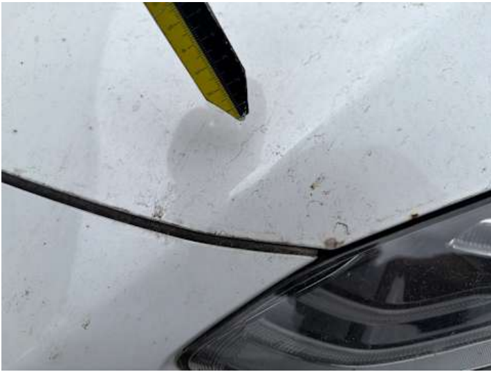
Motorhaube (Lackschaden, Kratzer, Steinschlag, Rost)
