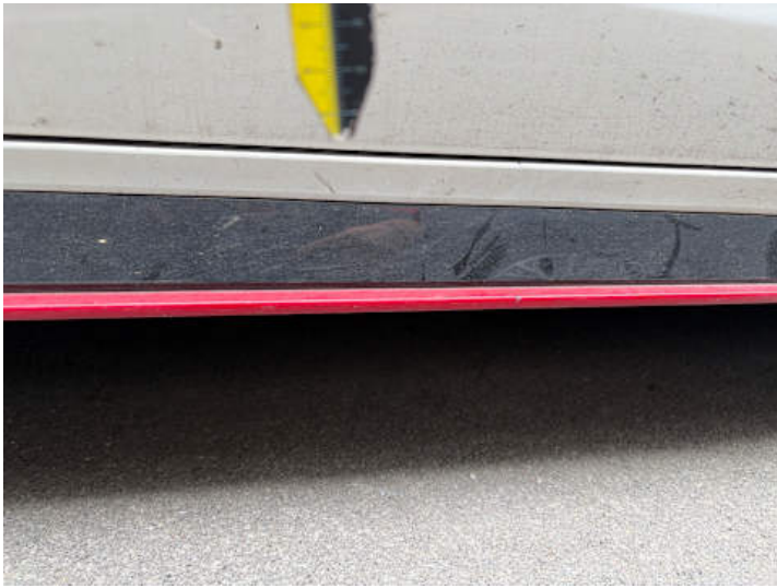
Schweller rechts (Lackschaden, Kratzer)
