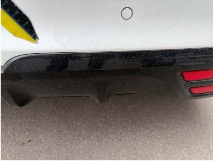
Stoßstange hinten (Lackschaden, Kratzer)
