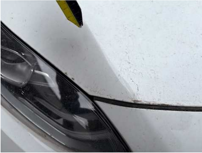
Motorhaube (Lackschaden, Kratzer, Steinschlag, Rost)
