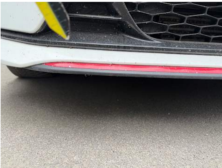
Stoßstange vorne (Lackschaden, Kratzer)
