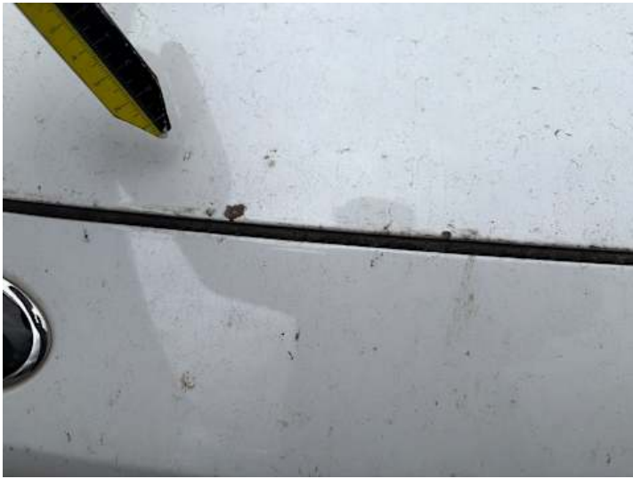
Motorhaube (Lackschaden, Kratzer, Steinschlag, Rost)
