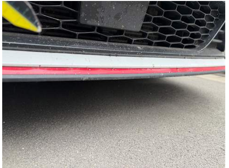
Stoßstange vorne (Lackschaden, Kratzer)
