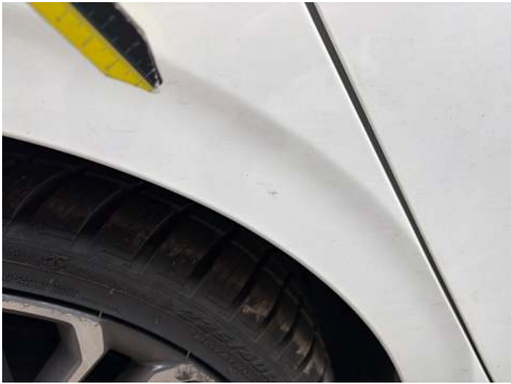
Seitenteil hinten rechts (Lackschaden, Kratzer)
