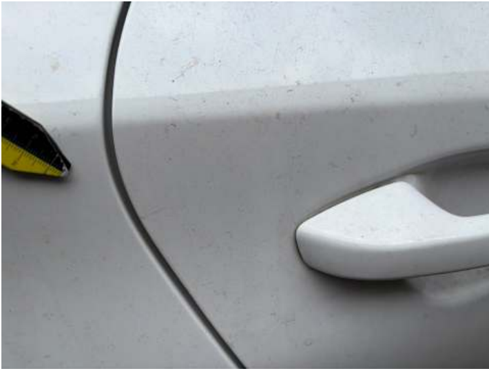
Türe hinten rechts (Lackschaden, Kratzer)
