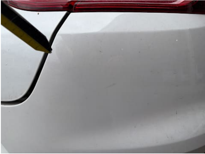
Stoßstange hinten (Lackschaden, Kratzer)
