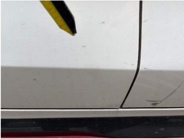
Türe hinten rechts (Lackschaden, Kratzer)
