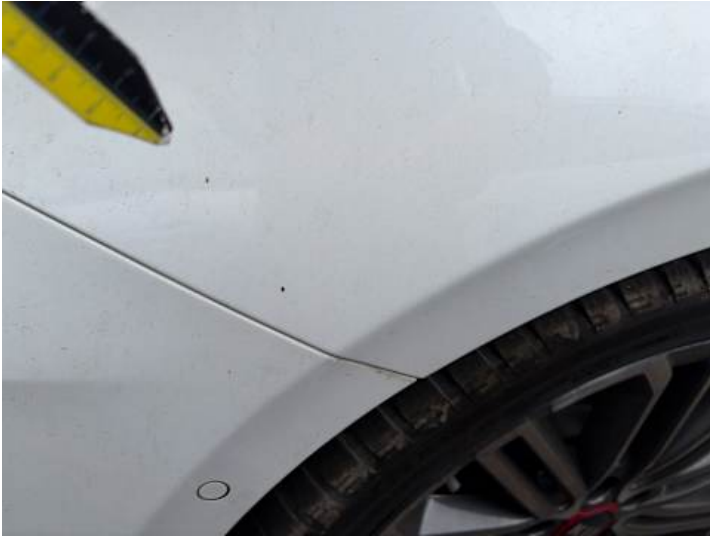
Kotflügel vorne links (Lackschaden, Kratzer)
