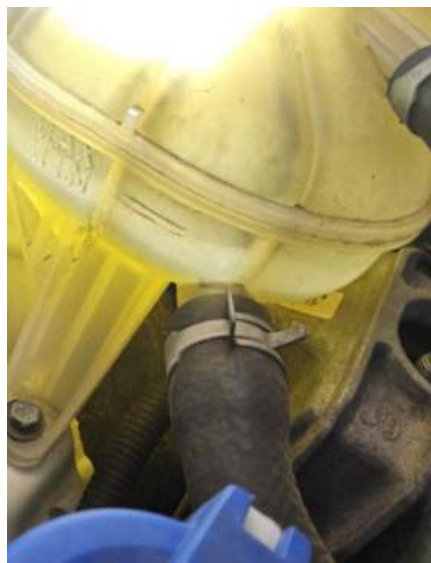
Motorhaube (Anderer Schaden): Kühlwasser unter min
