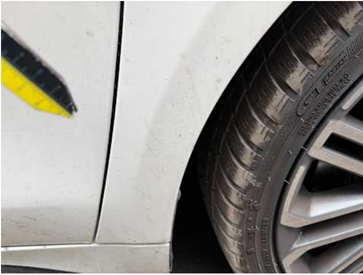
Kotflügel vorne rechts (Lackschaden, Kratzer)
