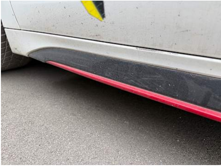
Schweller links (Lackschaden, Kratzer)
