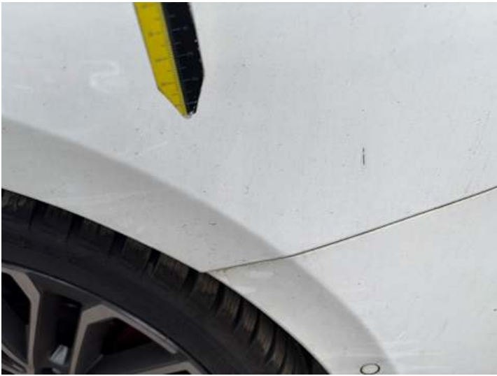
Seitenteil hinten links (Lackschaden, Kratzer, Rost)
