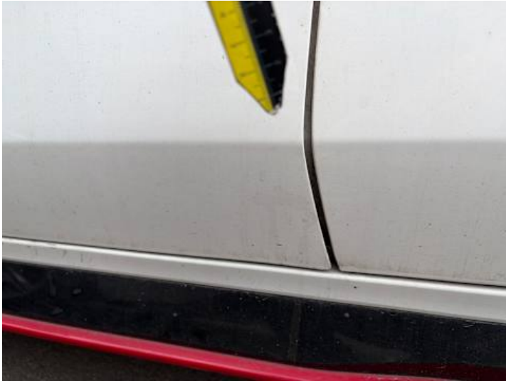
Fahrtür (Lackschaden, Kratzer)
