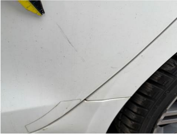
Türe hinten links (Lackschaden, Kratzer)
