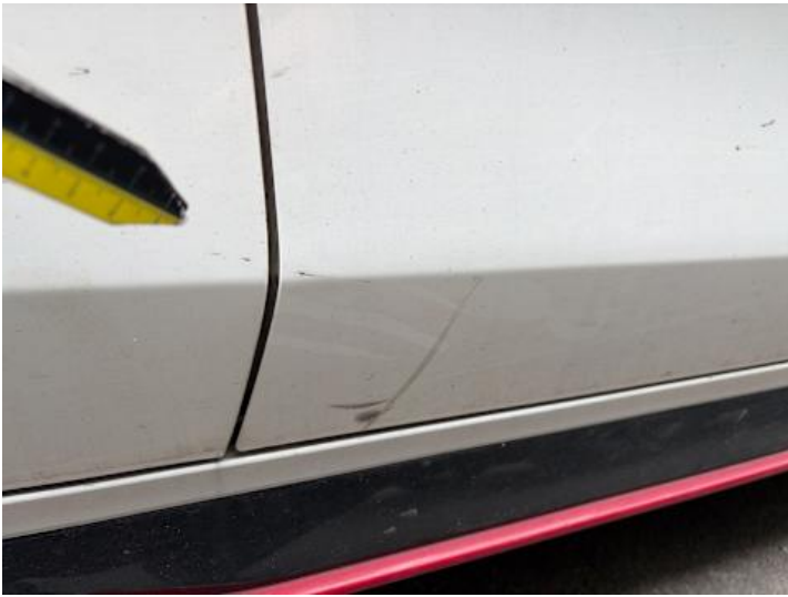
Beifahrertür (Lackschaden, Kratzer)
