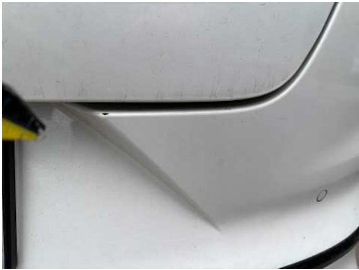
Stoßstange hinten (Lackschaden, Kratzer)
