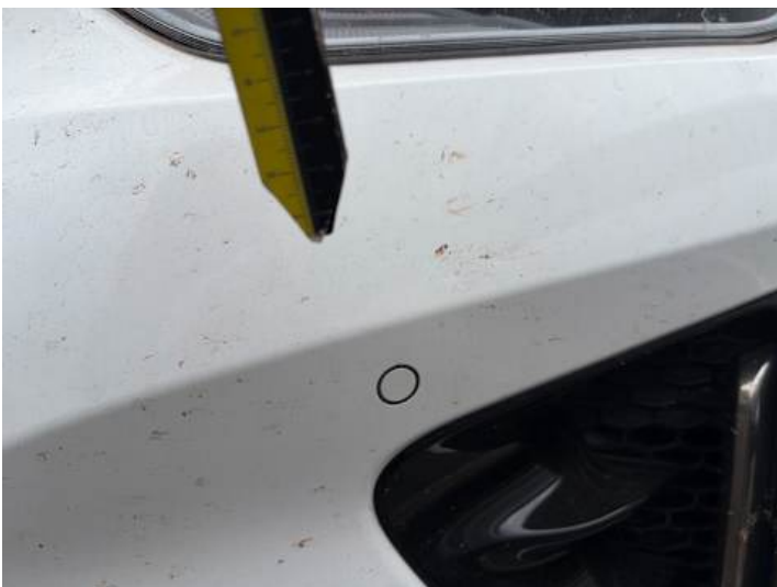
Stoßstange vorne (Lackschaden, Kratzer)
