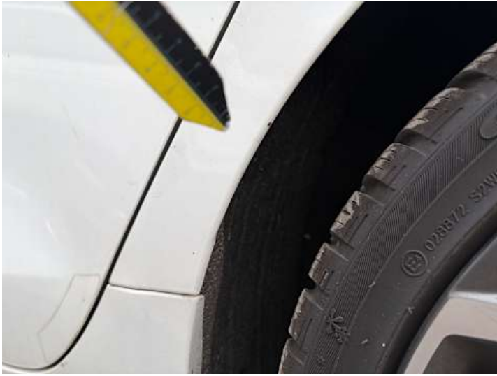
Seitenteil hinten links (Lackschaden, Kratzer, Rost)
