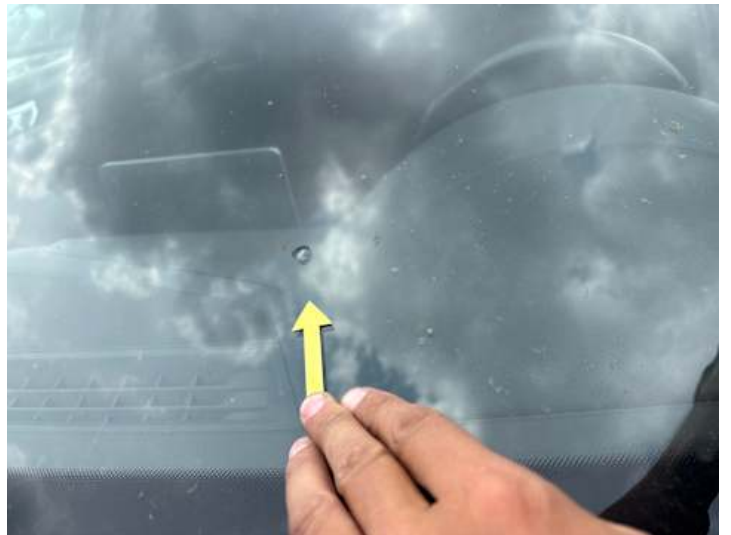
Windschutzscheibe (Steinschlag, Riss/Bruch)
