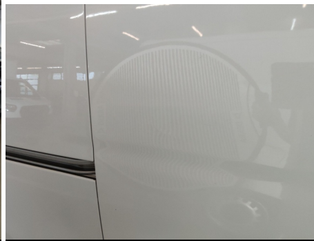
Tür / Rechts / Delle
