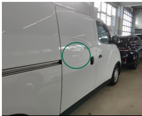
Tür / Rechts / Delle
