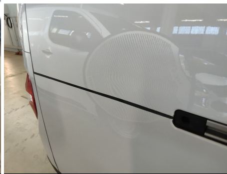
Seitenwand / Hinten Rechts / Delle
