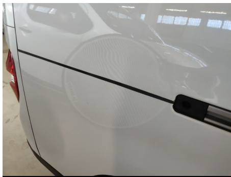
Seitenwand / Hinten Rechts / Delle
