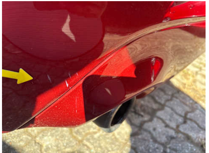
Stoßstange hinten (Kratzer)
