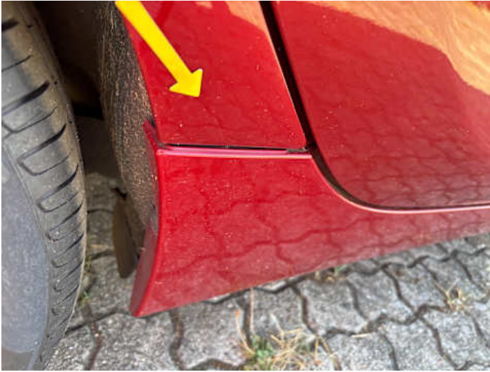
Schweller rechts (Spaltmaße ungenau)
