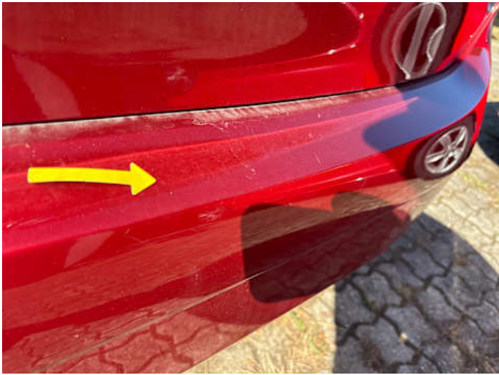
Stoßstange hinten (Kratzer)
