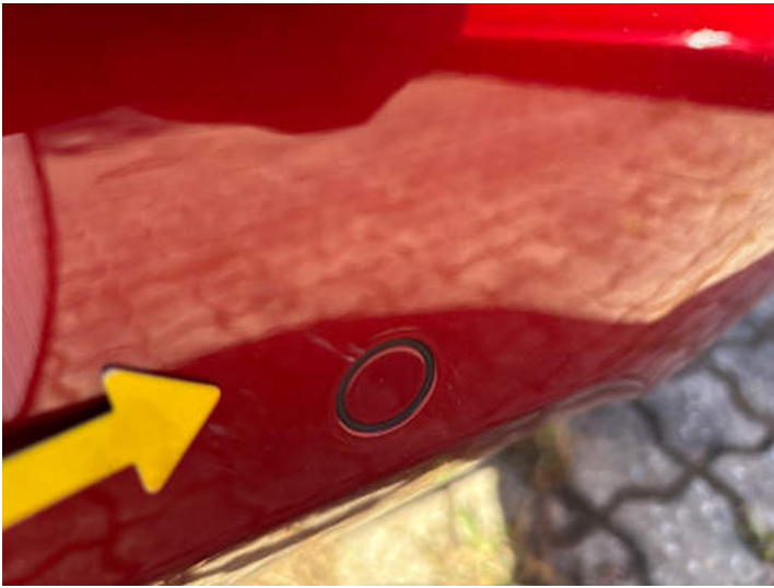
Stoßstange hinten (Kratzer)
