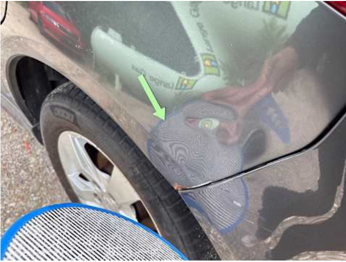
Seitenteil hinten links (Kratzer, Delle, Lackschaden, Rost)
