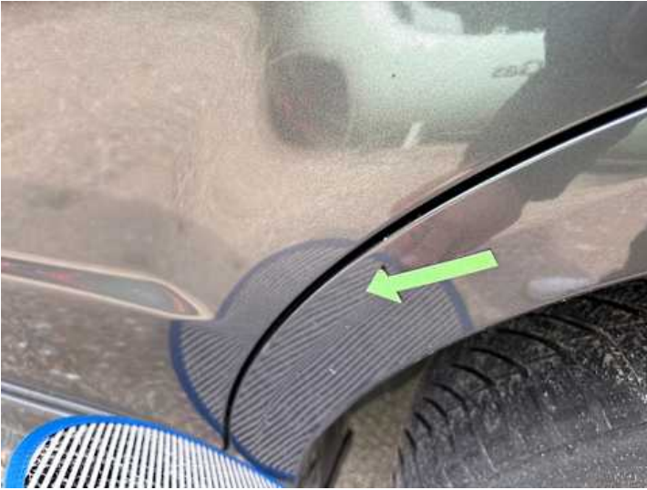
Seitenteil hinten links (Kratzer, Delle, Lackschaden, Rost)
