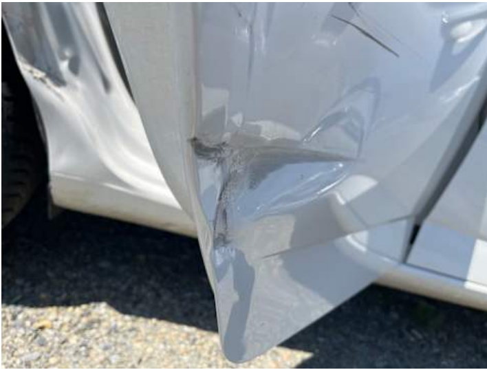
Türe hinten rechts (Verformung, Lackschaden)
