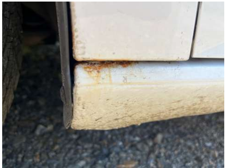
Schweller links (Rost)
