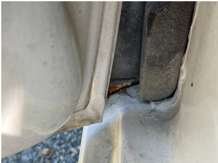
Kotflügel vorne links (Rost)
