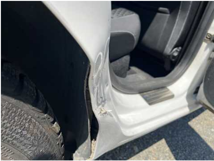
Seitenteil hinten rechts (Verformung, Lackschaden)
