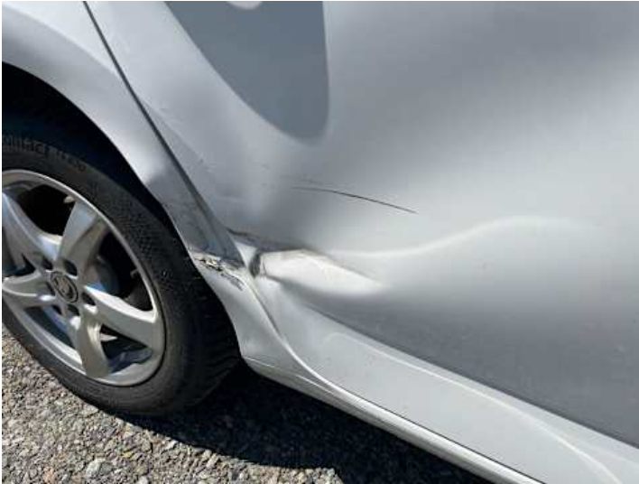
Türe hinten rechts (Verformung, Lackschaden)
