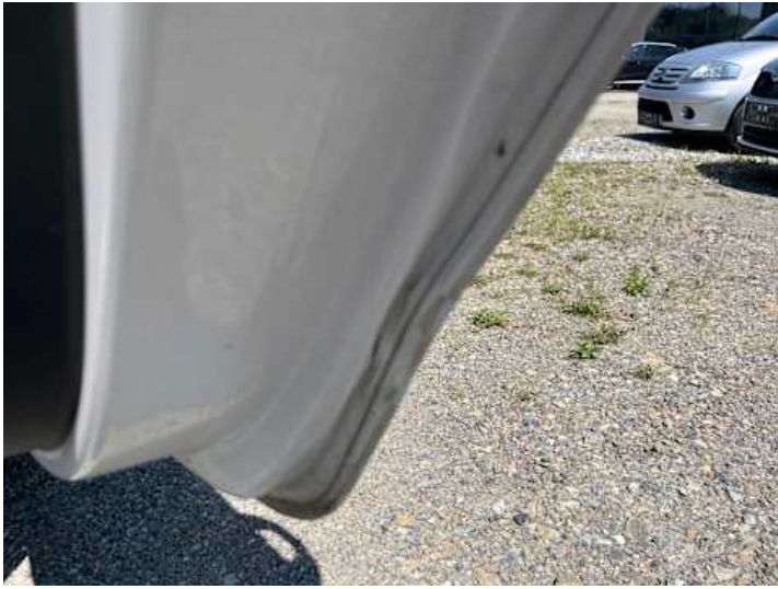
Türe hinten rechts (Verformung, Lackschaden)
