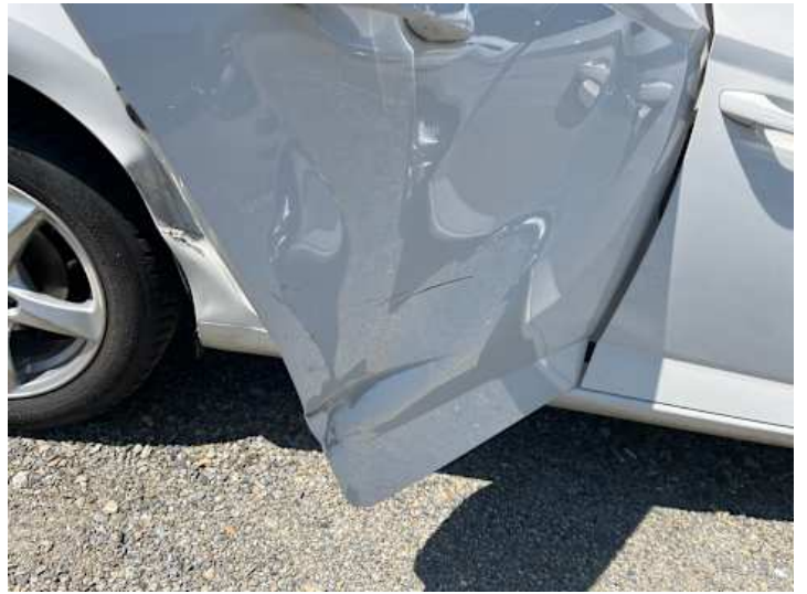
Türe hinten rechts (Verformung, Lackschaden)
