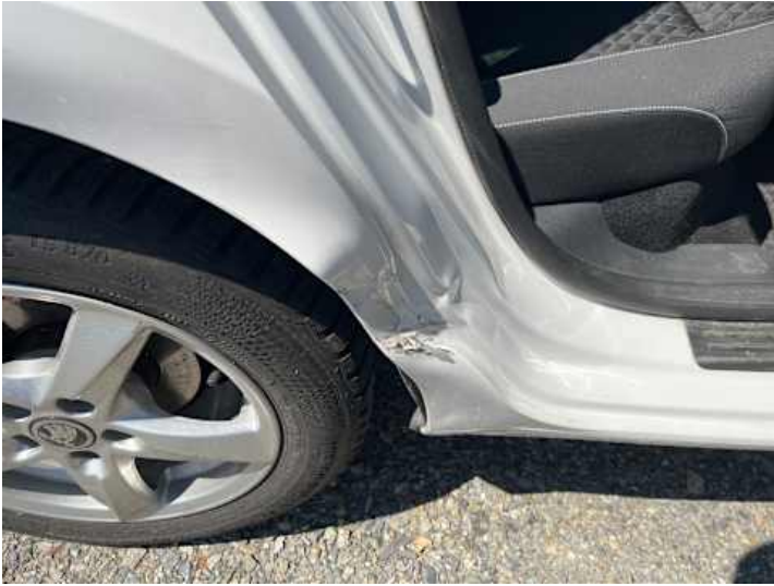
Seitenteil hinten rechts (Verformung, Lackschaden)
