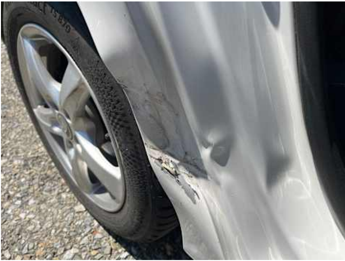
Seitenteil hinten rechts (Verformung, Lackschaden)
