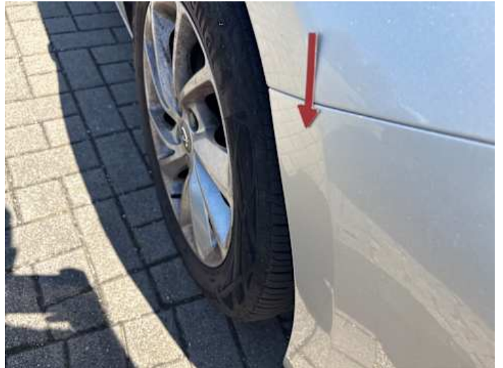
Stoßstange vorne (Verformung)
