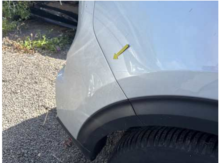
Stoßstange hinten (Unsachgemäß instand gesetzt)
