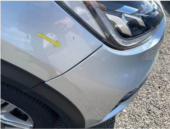
Stoßstange vorne (Spaltmaße ungenau, Unsachgemäß instand gesetzt)
