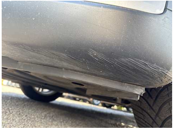
Stoßstange vorne (Lackschaden, Kratzer)
