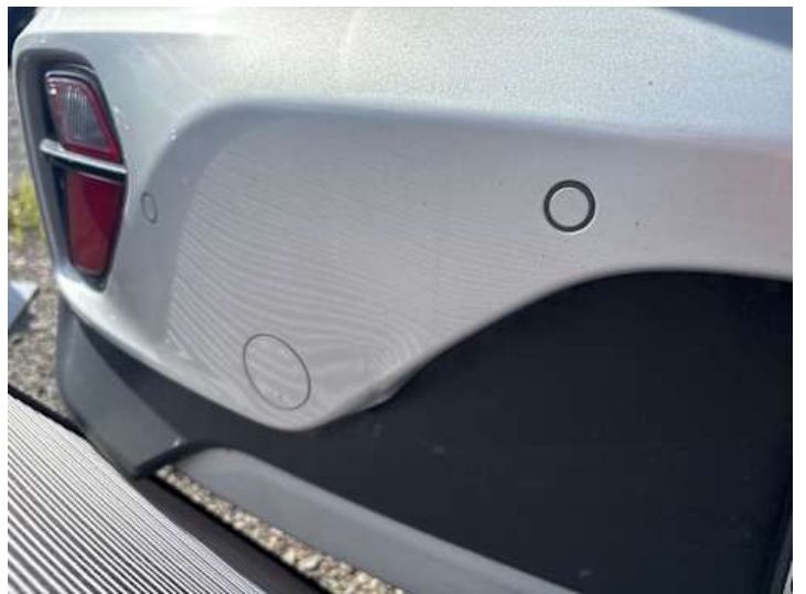
Stoßstange hinten (Verformung)
