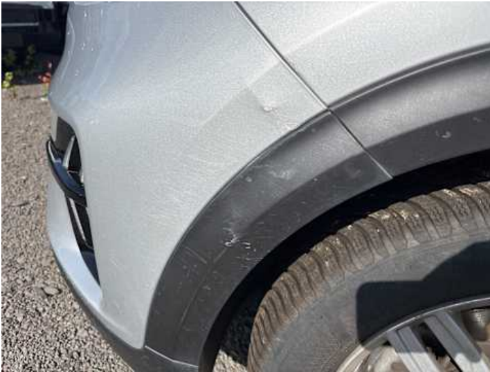
Stoßstange vorne (Lackschaden, Kratzer)
