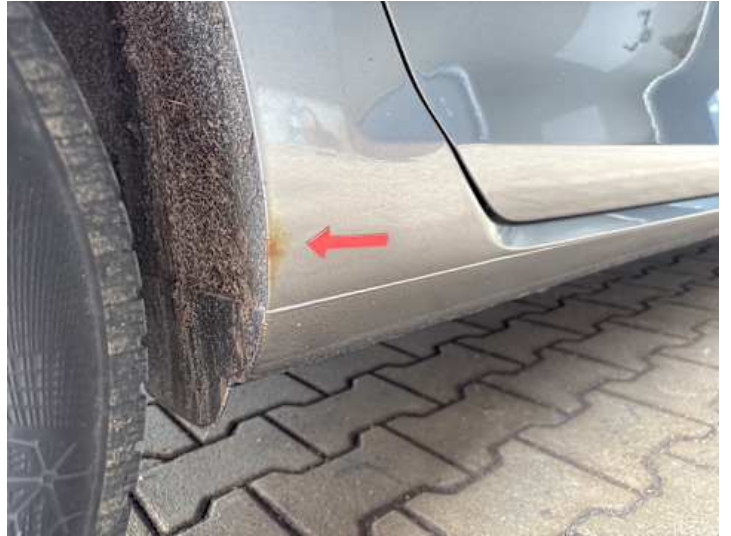
Schweller rechts (Rost)
