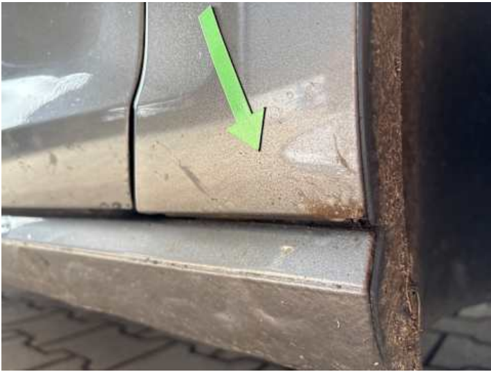
Kotflügel vorne rechts (Delle, Rost)
