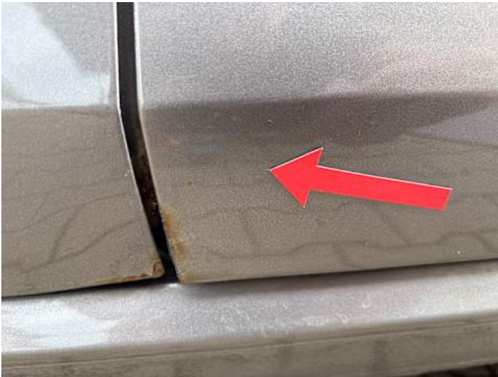
Türe hinten links (Rost)
