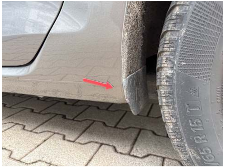
Schweller links (Rost)
