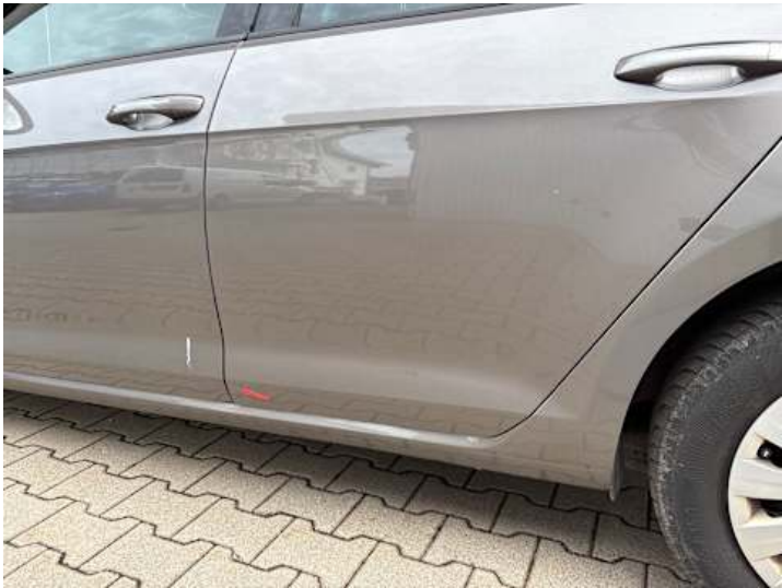
Türe hinten links (Rost)
