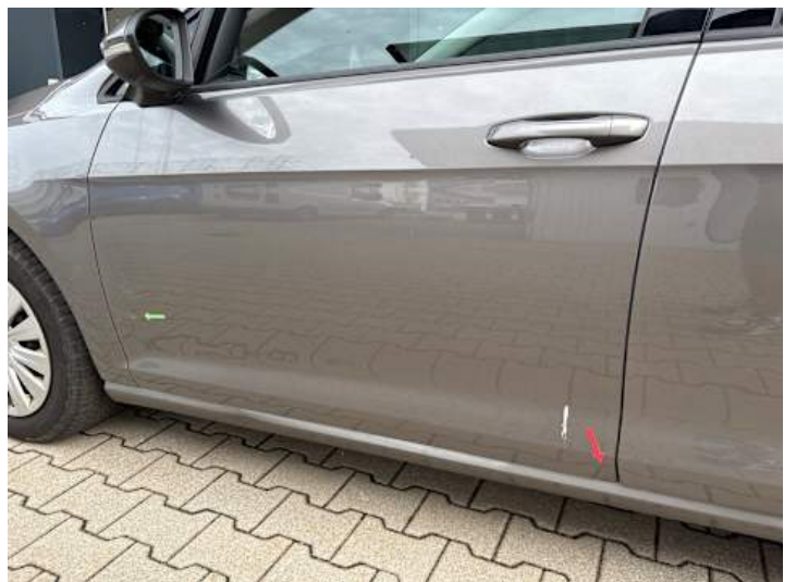
Fahrtür (Delle, Rost)
