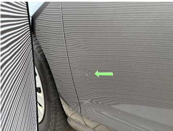
Fahrtür (Delle, Rost)
