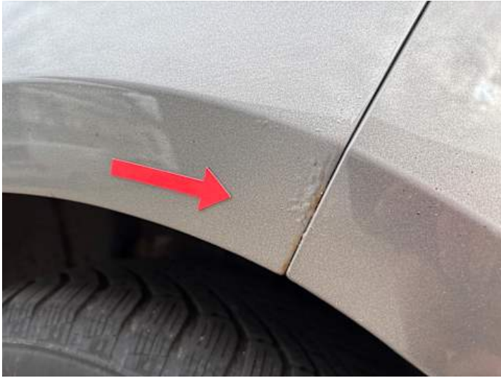
Seitenteil hinten links (Rost)
