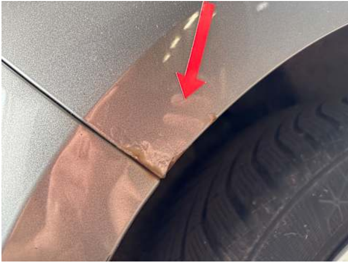
Seitenteil hinten rechts (Rost)
