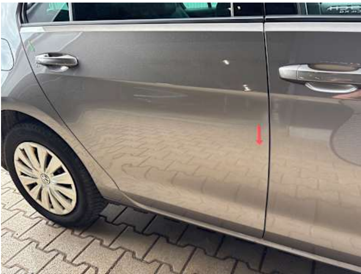
Türe hinten rechts (Delle, Rost)
