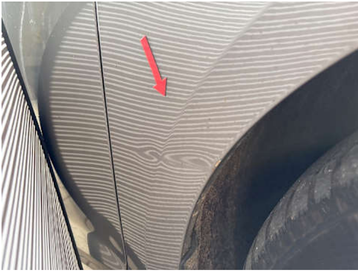
Kotflügel vorne rechts (Delle, Rost)
