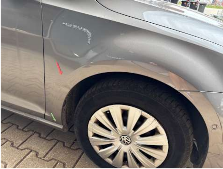
Kotflügel vorne rechts (Delle, Rost)
