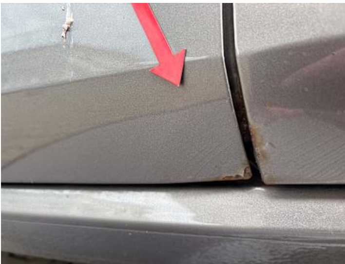
Fahrtür (Delle, Rost)
