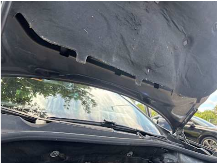
Motorhaube (Anderer Schaden): Dämmung beschädigt
