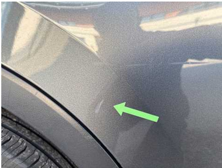
Türe hinten rechts (Delle, Kratzer)
