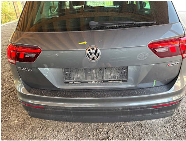
Heckklappe (Delle, Lackschaden)
