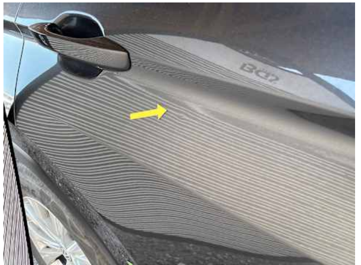
Türe hinten rechts (Delle, Kratzer)
