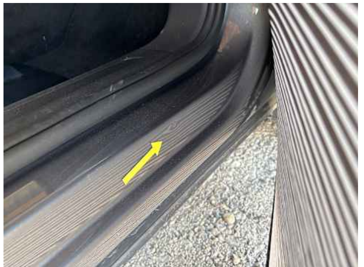
Schweller rechts (Delle)
