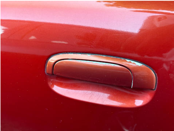
Türe hinten links (Lackschaden)
