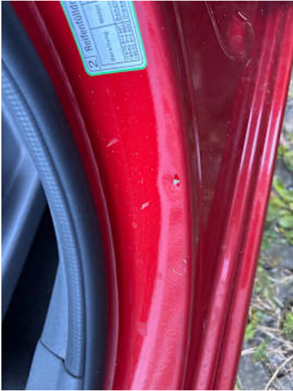
Schweller links (Kratzer, Delle)
