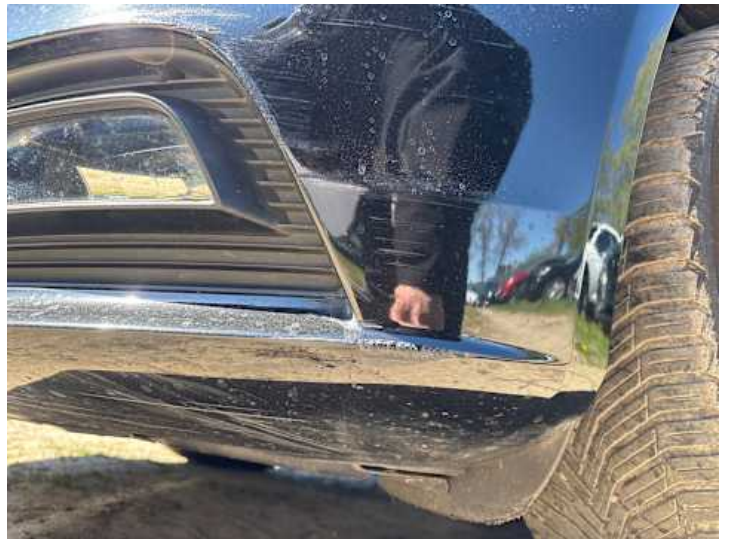
Stoßstange vorne (Kratzer, Verformung)
