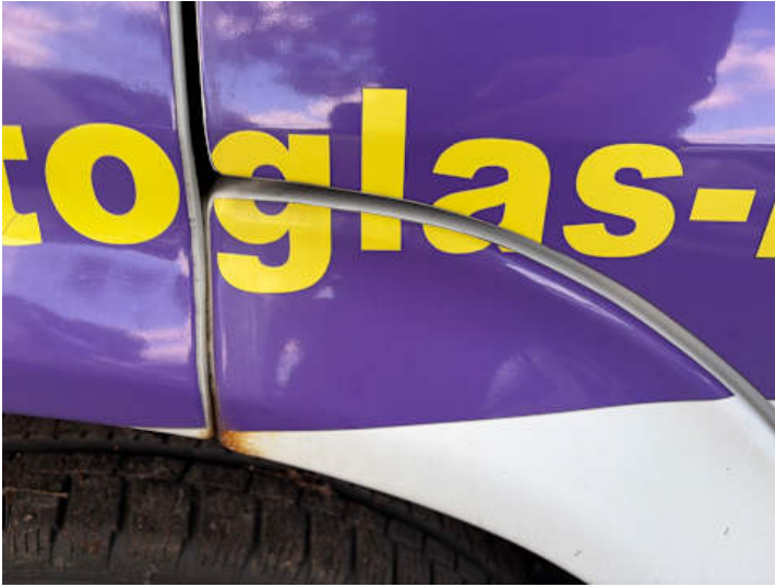
Fahrtür (Rost, Lackschaden)
