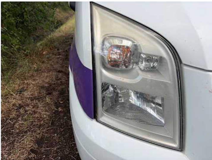
Kotflügel vorne rechts (Spaltmaße ungenau)
