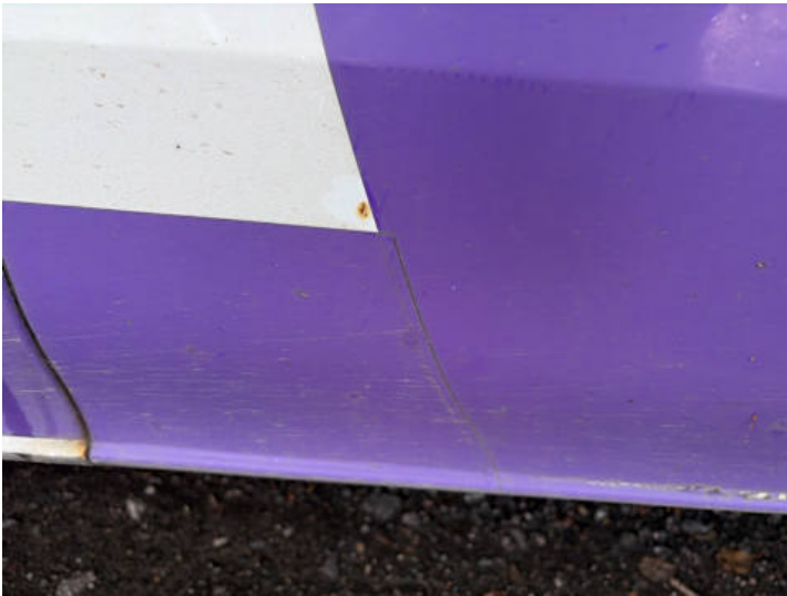
Seitenteil hinten links (Rost)
