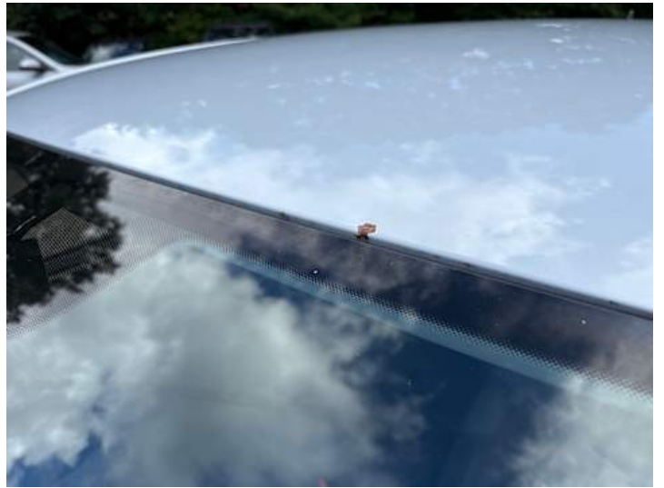
Dach (Steinschlag, Rost)
