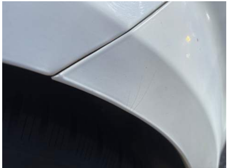
Stoßstange hinten (Riss/Bruch, Verformung)
