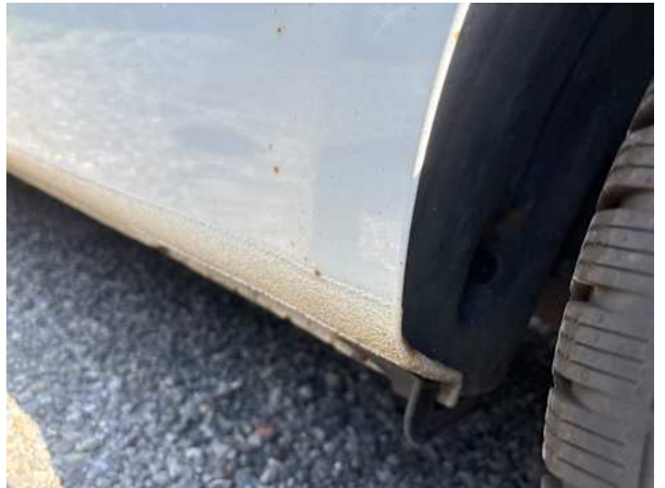
Schweller links (Rost)
