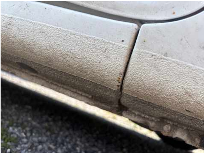
Schweller rechts (Rost)
