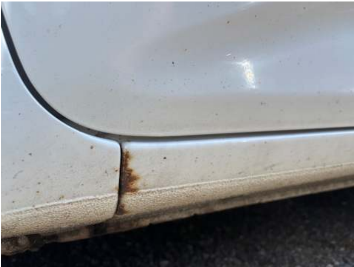
Schweller links (Rost)
