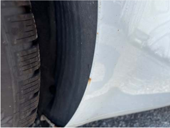
Seitenteil hinten rechts (Rost)
