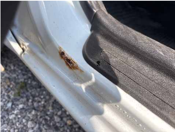
Schweller links (Rost)
