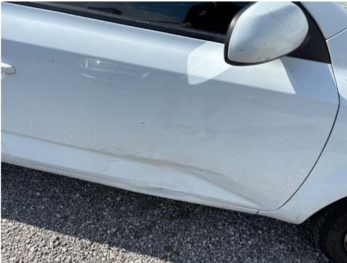
Beifahrertür (Verformung, Kratzer, Spaltmaße ungenau)
