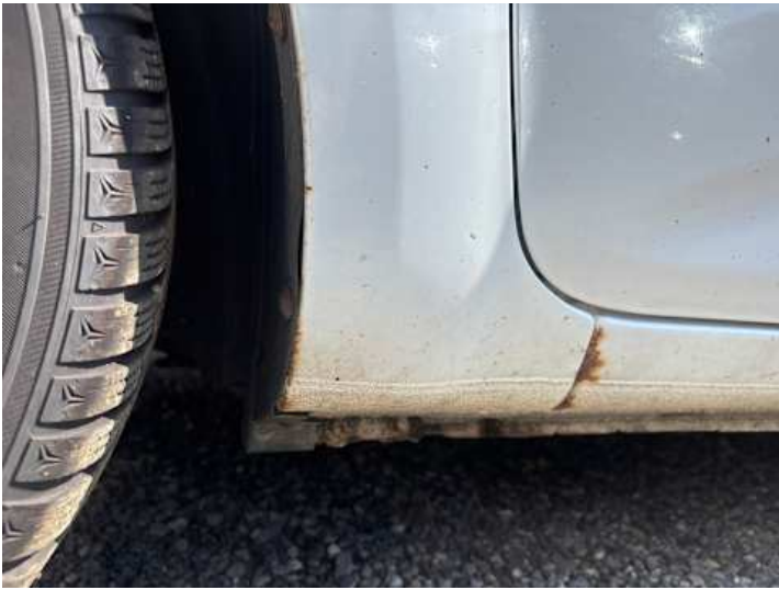
Kotflügel vorne links (Rost)
