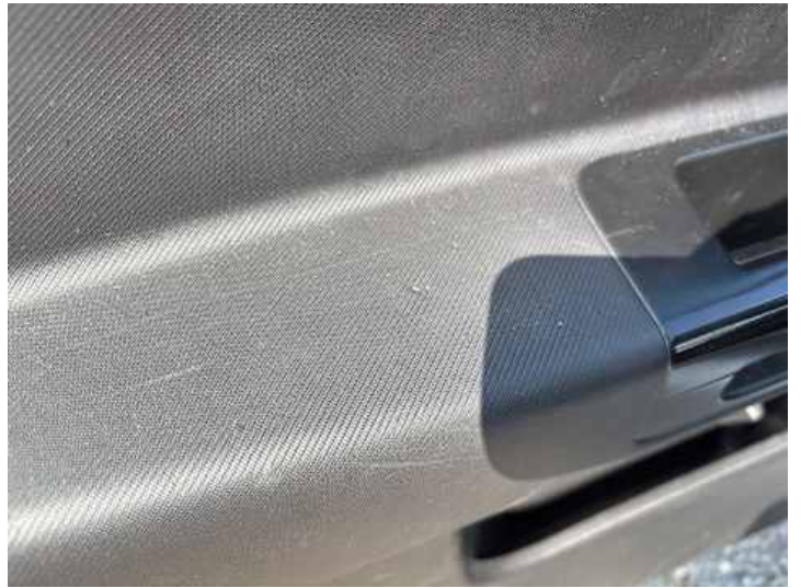
Innenraum (Anderer Schaden): Druckstellen
