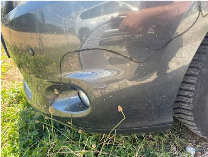
Stoßstange vorne (Spaltmaße ungenau, Kratzer, Riss/Bruch)
