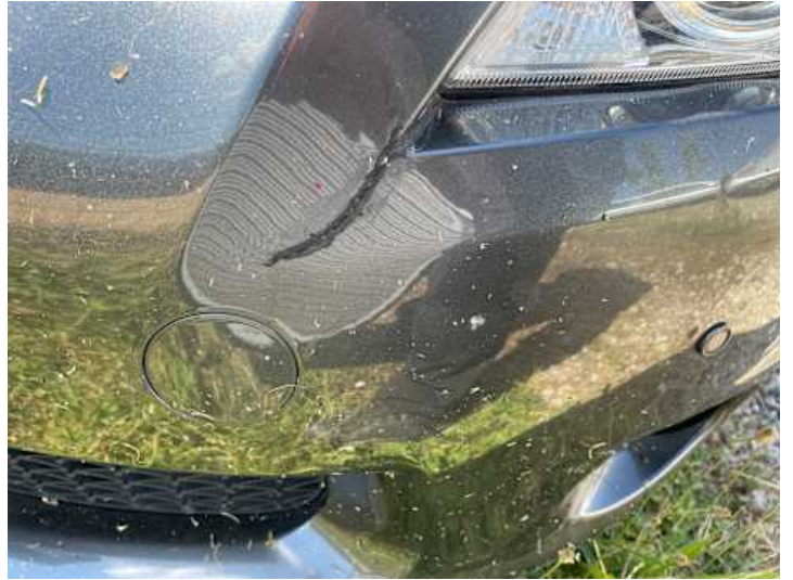
Stoßstange vorne (Spaltmaße ungenau, Kratzer, Riss/Bruch)
