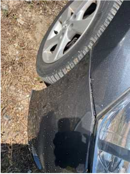
Stoßstange vorne (Spaltmaße ungenau, Kratzer, Riss/Bruch)
