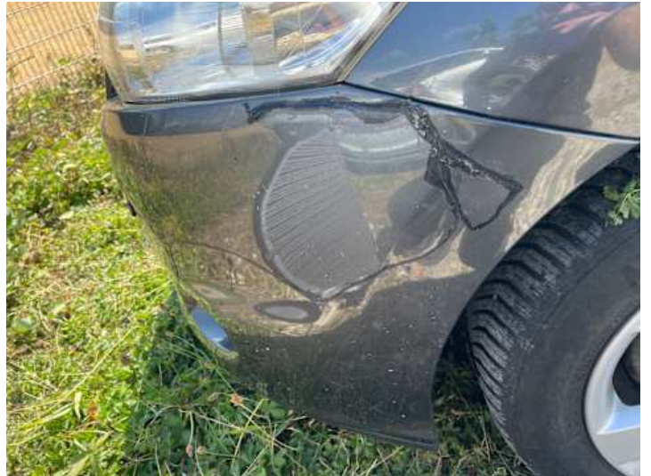
Stoßstange vorne (Spaltmaße ungenau, Kratzer, Riss/Bruch)
