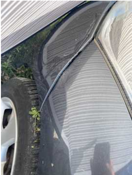
Kotflügel vorne links (Delle, Kratzer)
