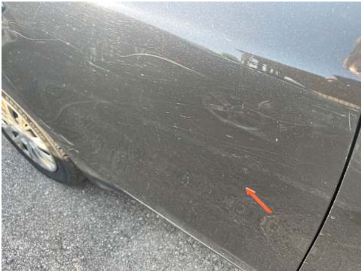
Türe hinten rechts (Kratzer, Lackschaden)
