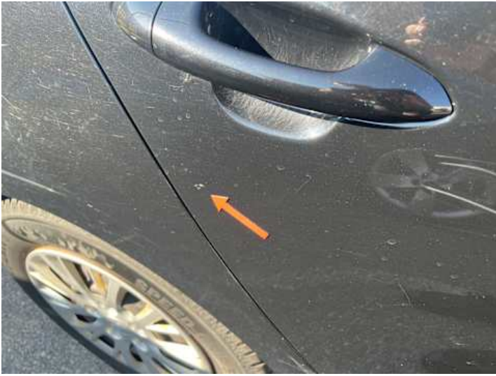
Türe hinten rechts (Kratzer, Lackschaden)
