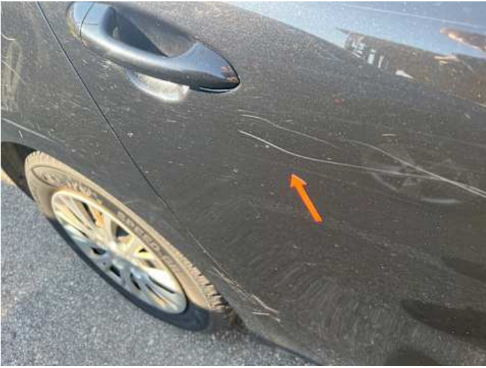
Türe hinten rechts (Kratzer, Lackschaden)
