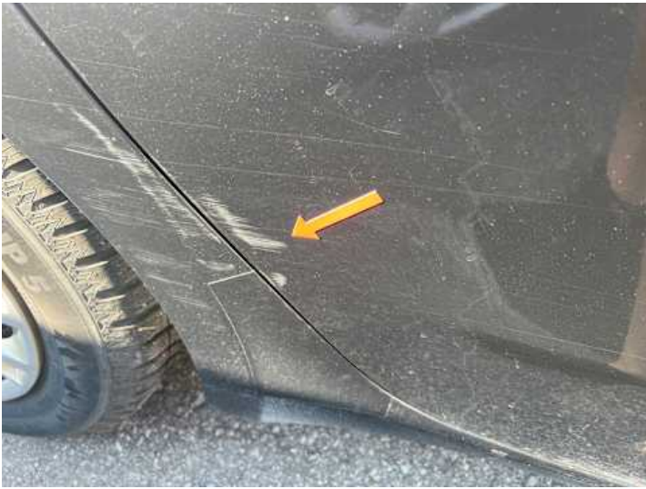
Türe hinten rechts (Kratzer, Lackschaden)
