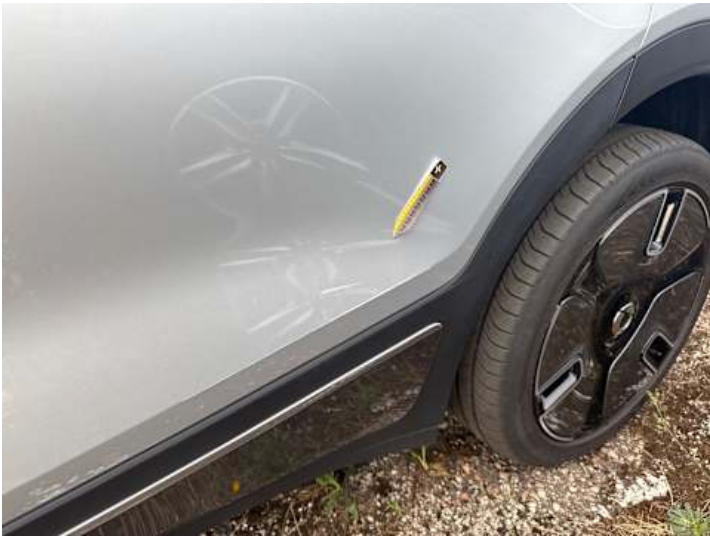
Türe hinten links (Kratzer)
