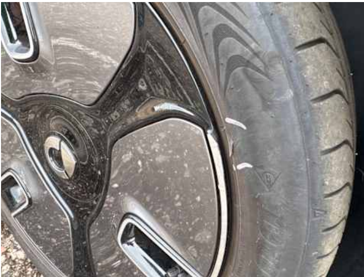
Rad (Kratzer, Riss/Bruch)
