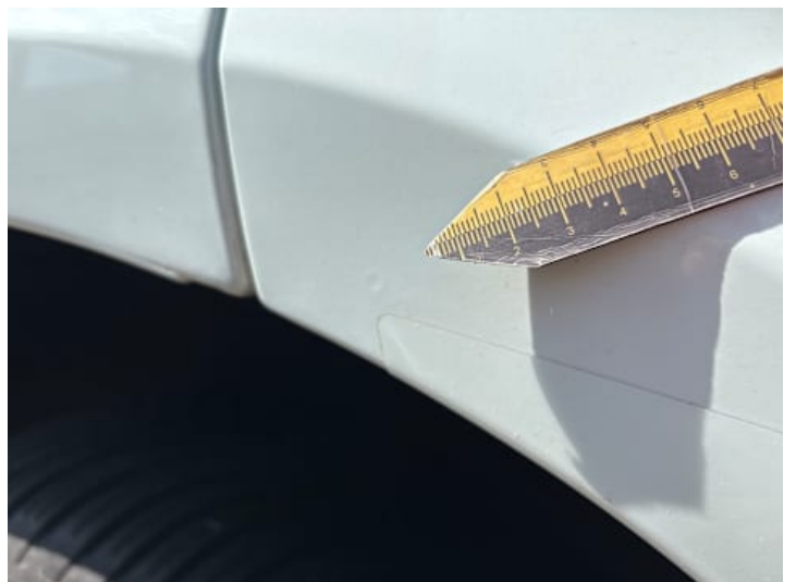
Türe hinten rechts (Unsachgemäß instand gesetzt)
