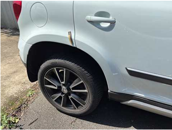
Seitenteil hinten rechts (Unsachgemäß instand gesetzt)
