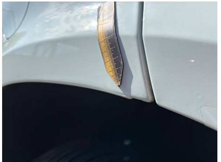
Seitenteil hinten rechts (Unsachgemäß instand gesetzt)
