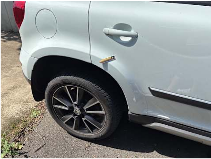
Türe hinten rechts (Unsachgemäß instand gesetzt)
