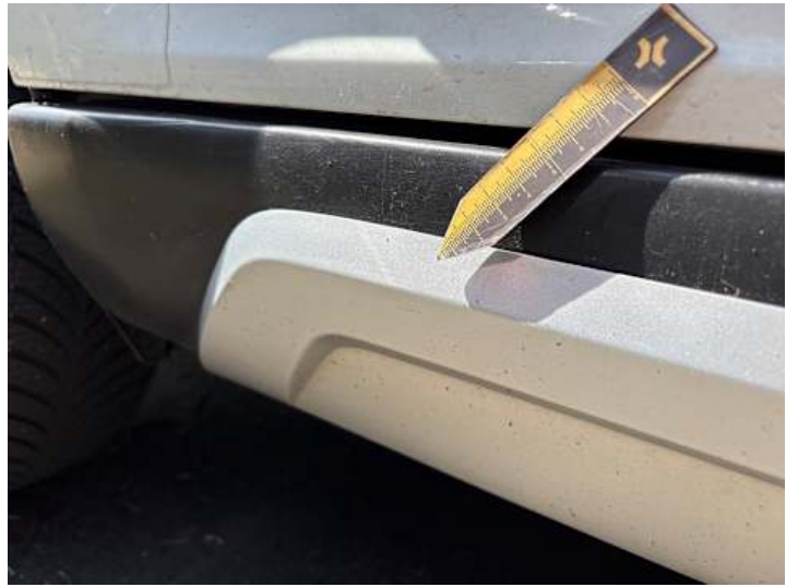
Schweller rechts (Lackschaden)
