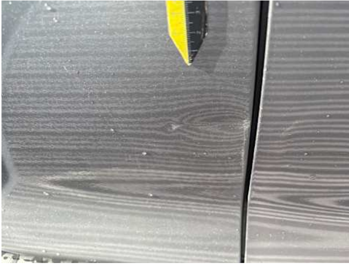
Türe hinten rechts (Delle, Kratzer)
