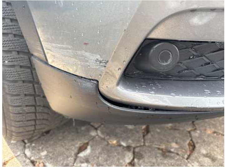
Stoßstange vorne (Spaltmaße ungenau, Kratzer)
