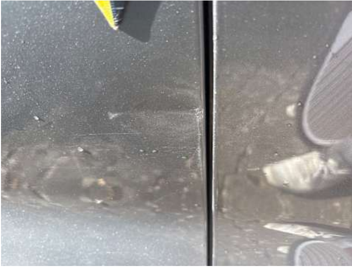
Türe hinten rechts (Delle, Kratzer)
