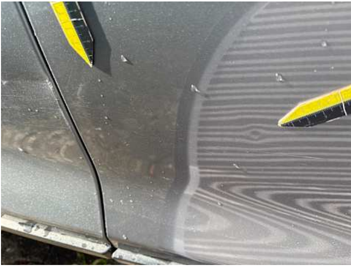
Beifahrertür (Delle, Kratzer)
