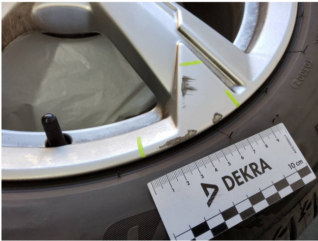
Alufelge vorne links verschrammt (DEKRA)
