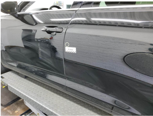
Tür hinten links, eingedellt, drücken (DEKRA)
