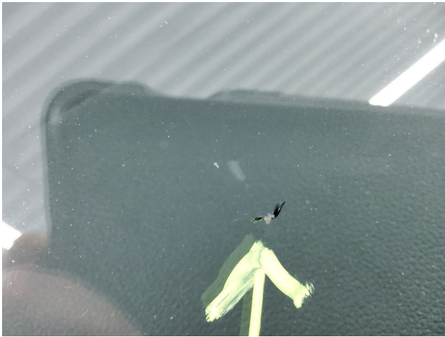
Windschutzscheibe Steinschläge mit Rissbildung (DEKRA)
