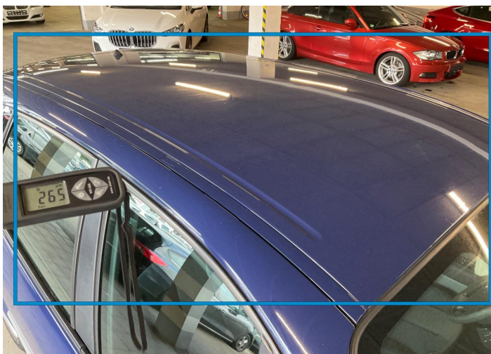
1. Dach Lack / schlechte Verarbeitung -
