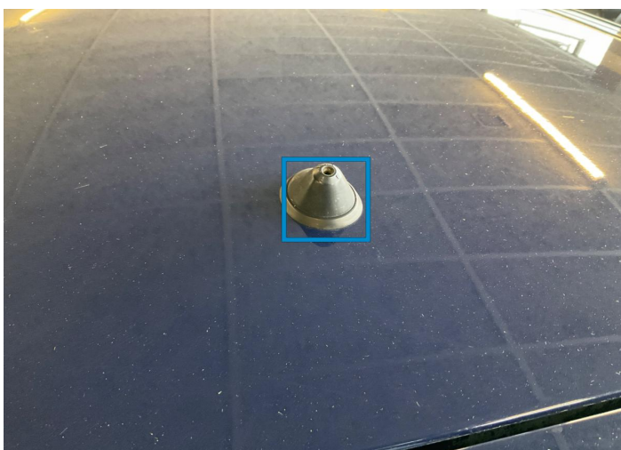
21. Antennenstange Fehlendes Teil -
