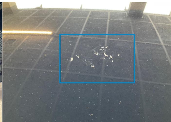
12. Dach Lack / Kratzer / Raster -
