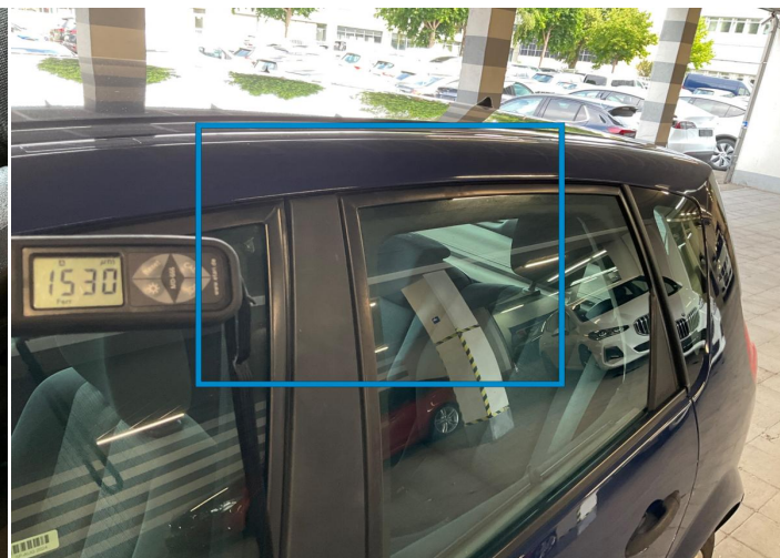
10. B - Säule / MitteLinks Lack / schlechte Verarbeitung -
