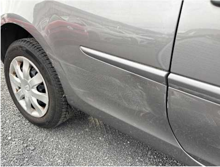
Seitenteil hinten rechts (Kratzer, Verformung)
