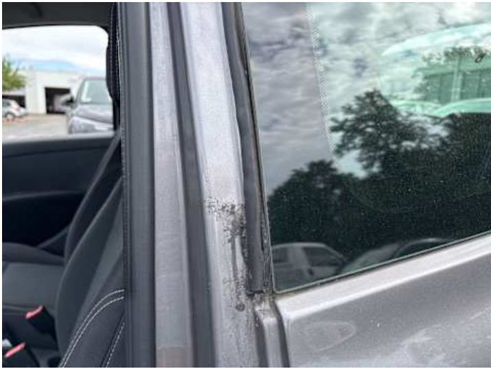
Fahrtür (Anderer Schaden): Dichtung defekt
