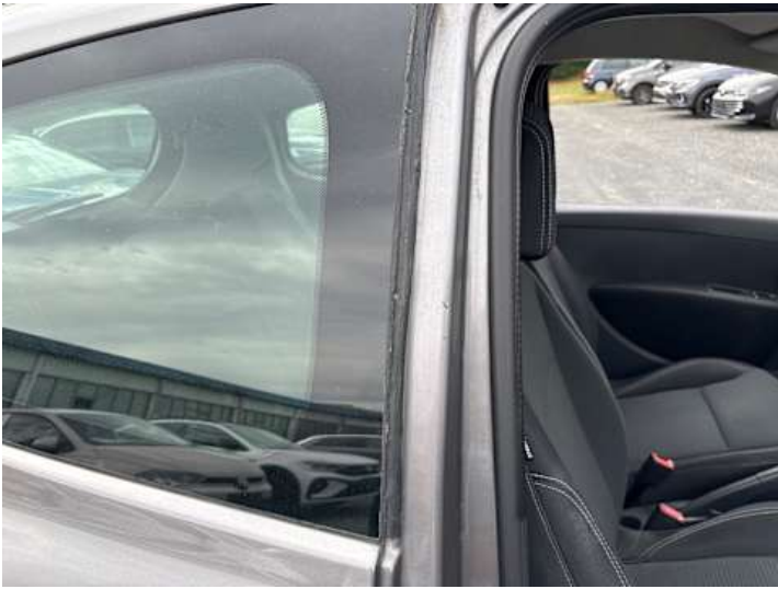
Seitenteil hinten rechts (Anderer Schaden): Dichtung defekt
