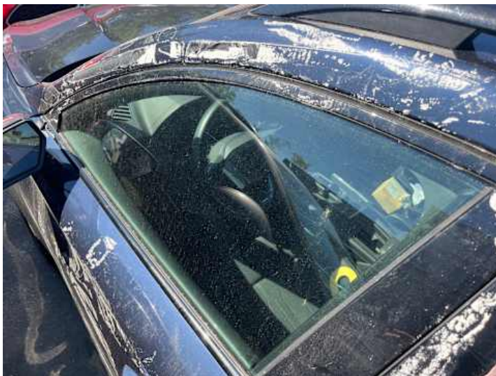
Fahrtür (Anderer Schaden): Klebereste
