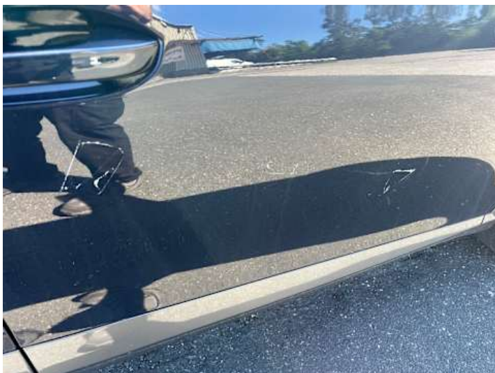
Beifahrtür (Anderer Schaden): Klebereste
