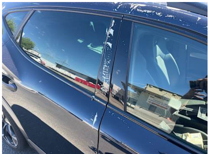
Türe hinten rechts (Anderer Schaden): Klebereste
