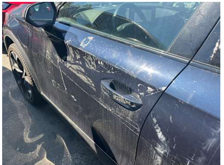
Fahrtür (Anderer Schaden): Klebereste
