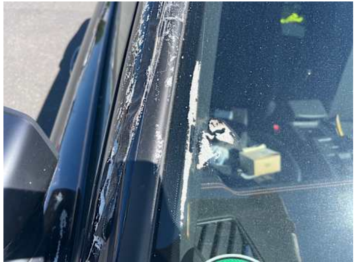
Windschutzscheibe (Anderer Schaden): Klebereste
