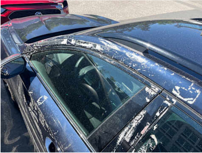
Seitenteil hinten links (Anderer Schaden): Klebereste
