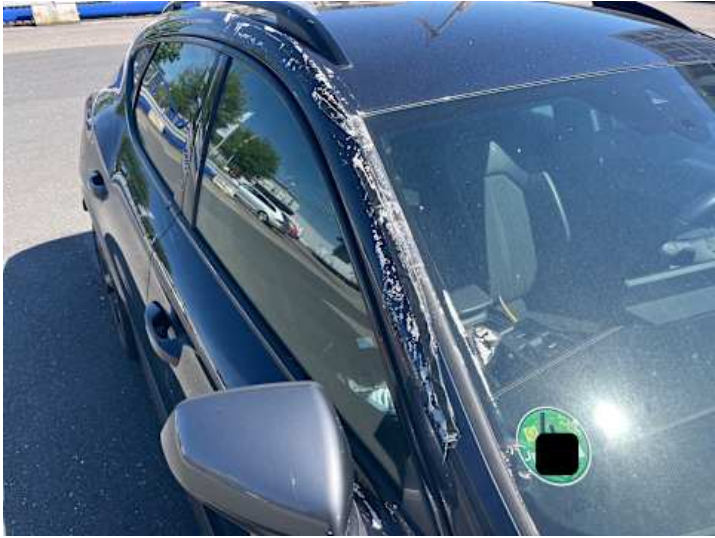
Seitenteil hinten rechts (Anderer Schaden): Klebereste
