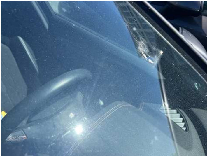
Windschutzscheibe (Anderer Schaden): Klebereste
