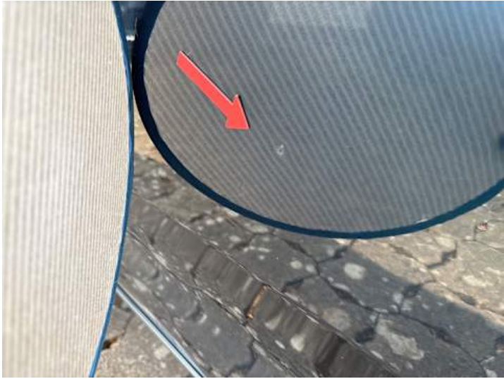
Türe hinten rechts (Lackschaden, Delle)
