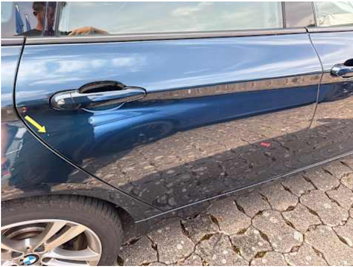
Türe hinten rechts (Lackschaden, Delle)
