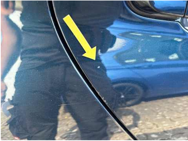
Türe hinten rechts (Lackschaden, Delle)
