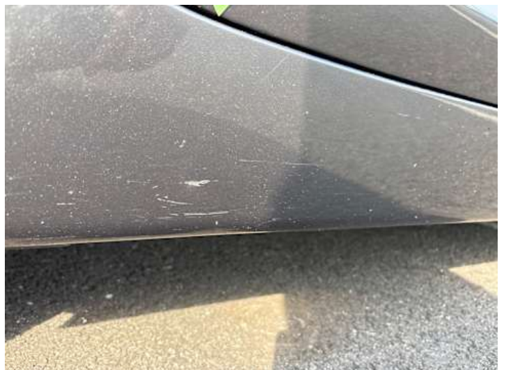
Schweller rechts (Kratzer)
