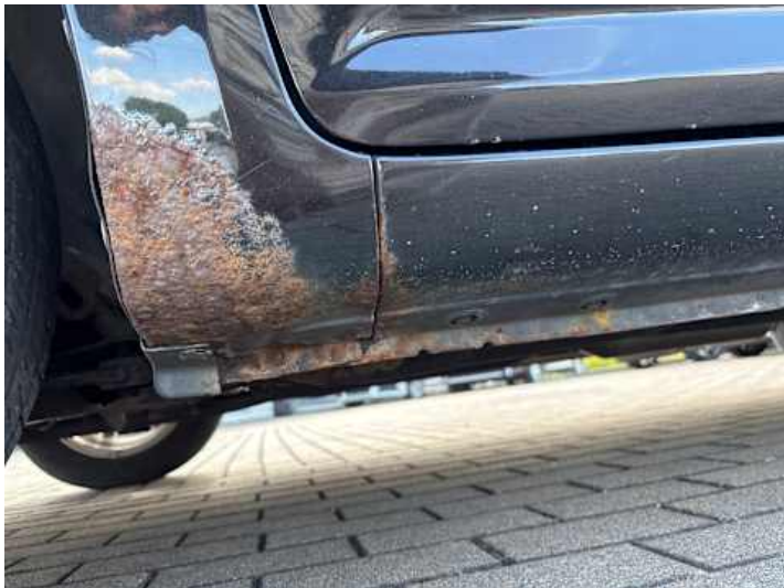
Schweller links (Rost, Lackschaden)
