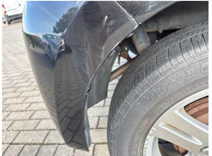
Stoßstange hinten (Kratzer, Lackschaden, Riss/Bruch)
