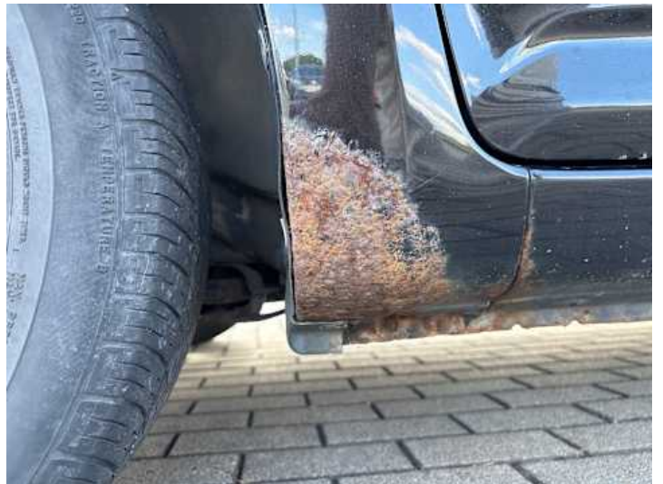
Kotflügel vorne links (Rost, Lackschaden)
