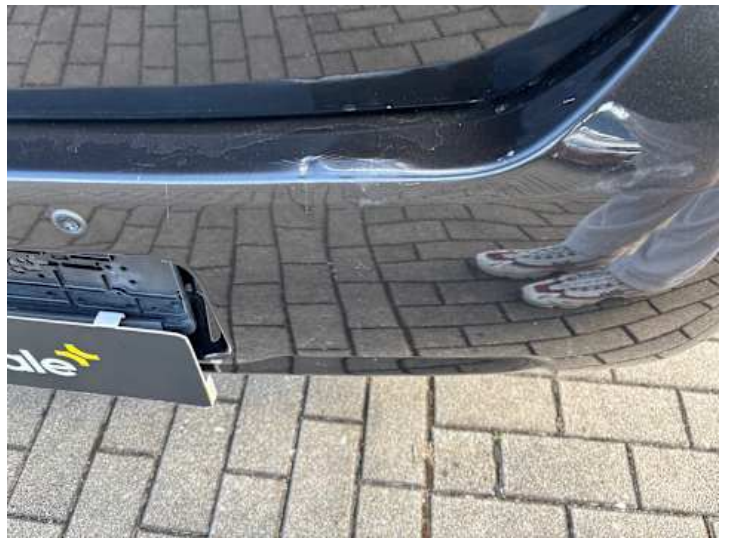
Stoßstange hinten (Kratzer, Lackschaden, Riss/Bruch)
