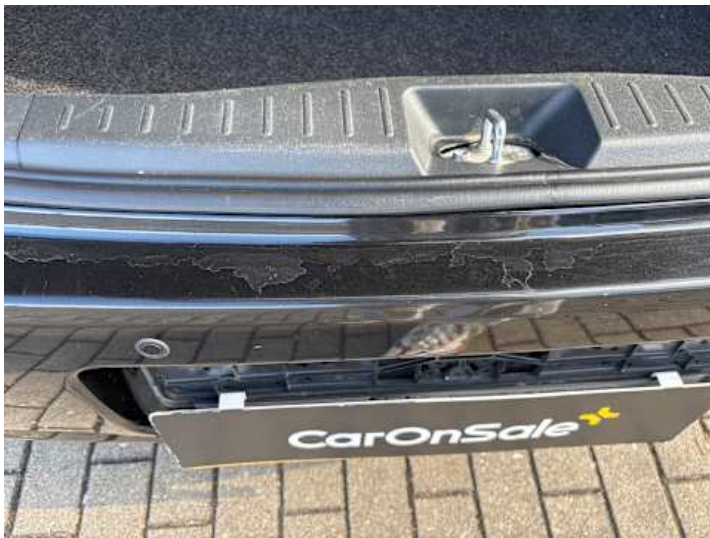
Stoßstange hinten (Kratzer, Lackschaden, Riss/Bruch)
