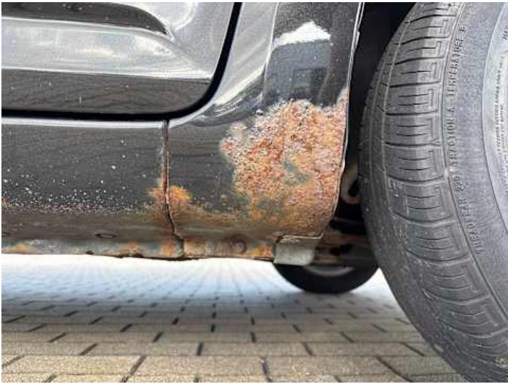
Kotflügel vorne rechts (Rost, Lackschaden)
