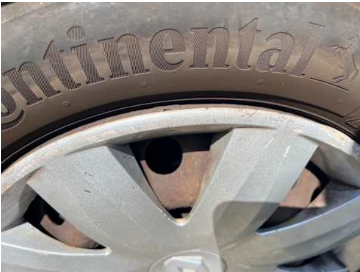
Rad (Ohne Luft, Rost)
