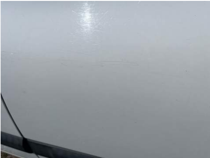
Türe hinten links (Kratzer, Delle)
