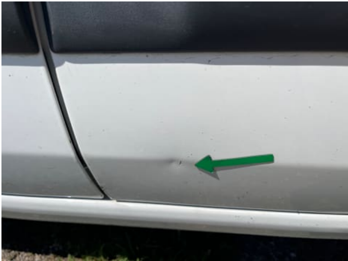
Türe hinten links (Kratzer, Delle)
