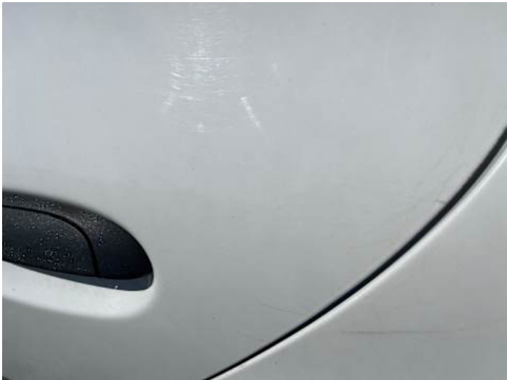
Türe hinten links (Kratzer, Delle)
