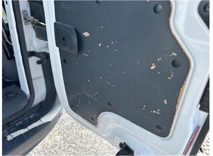
Innenraum (Riss/Bruch, Kratzer)
