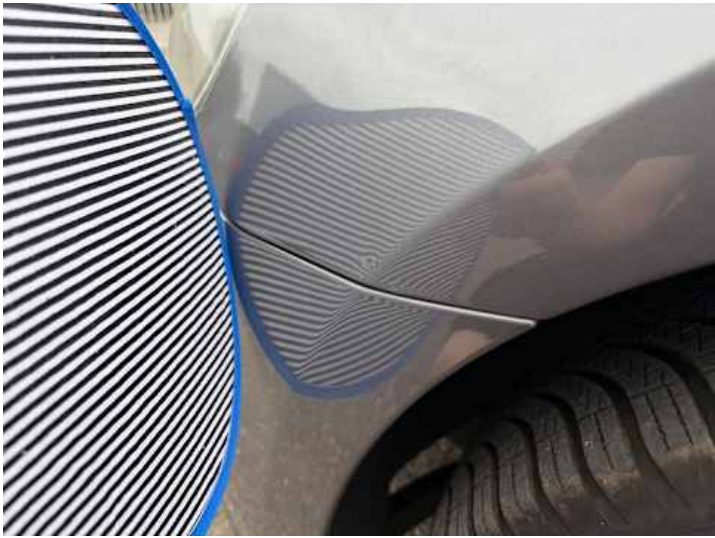
Kotflügel vorne links (Delle, Rost)
