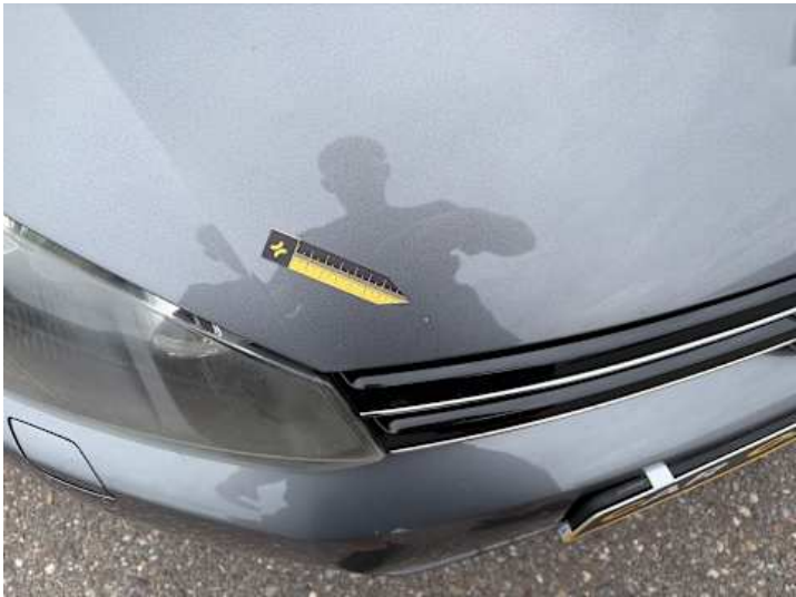
Motorhaube (Steinschlag, Rost)
