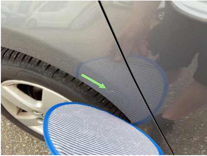
Seitenteil hinten rechts (Delle, Lackschaden)
