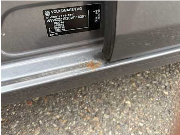
Schweller links (Rost)
