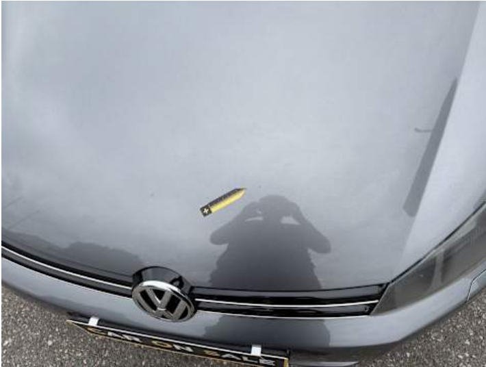
Motorhaube (Steinschlag, Rost)
