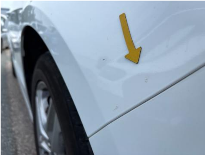
Kotflügel vorne rechts (Steinschlag)
