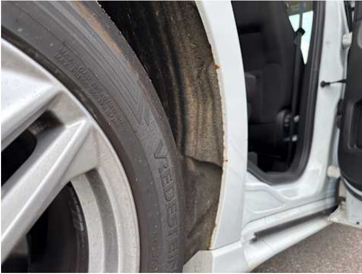
Seitenteil hinten rechts (Rost)
