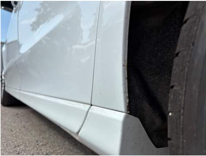
Seitenteil hinten links (Rost)
