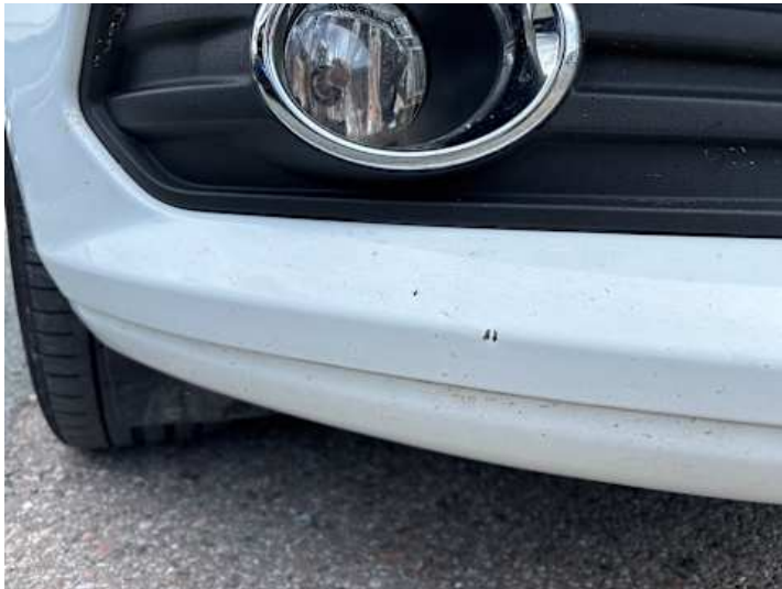
Stoßstange vorne (Lackschaden, Verformung)
