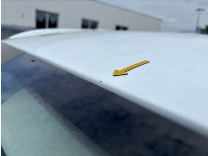
Dach (Rost, Steinschlag)
