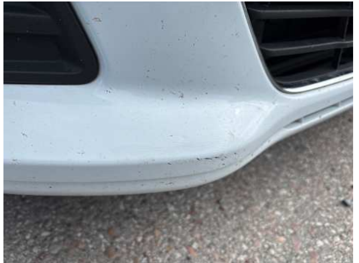
Stoßstange vorne (Lackschaden, Verformung)
