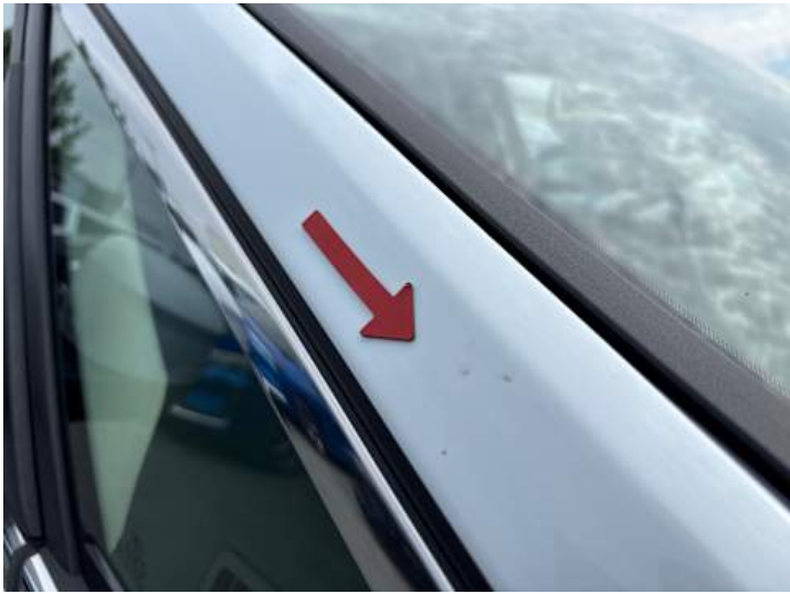
Seitenteil hinten rechts (Steinschlag)
