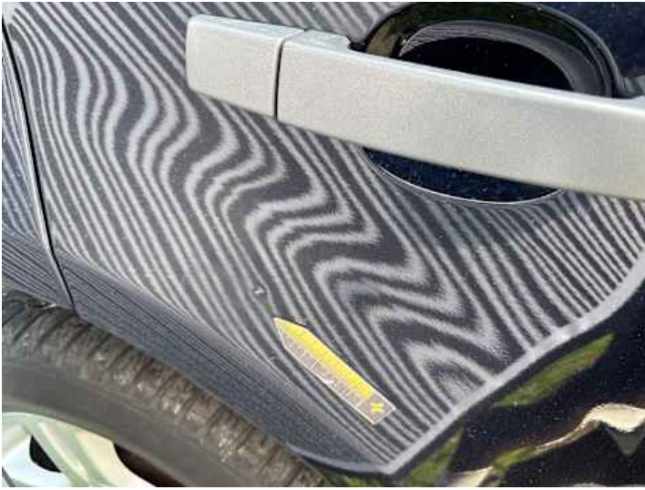
Türe hinten rechts (Steinschlag, Delle, Rost)
