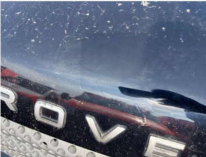
Motorhaube (Unsachgemäß instand gesetzt, Delle)
