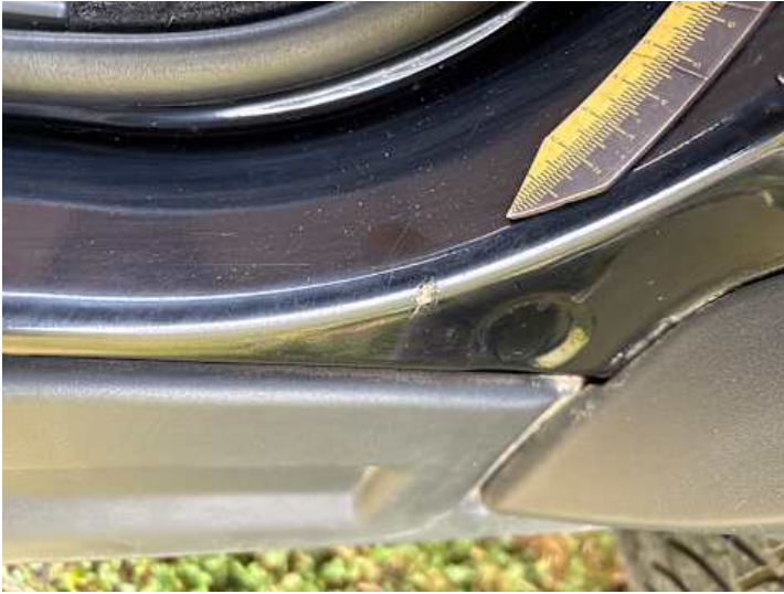
Schweller links (Rost)
