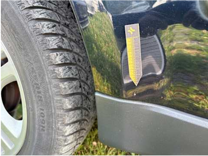
Türe hinten rechts (Steinschlag, Delle, Rost)
