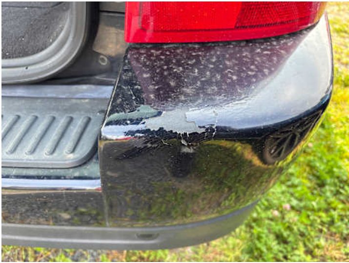
Stoßstange hinten (Lackschaden)
