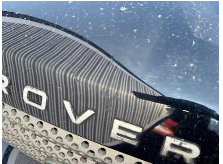
Motorhaube (Unsachgemäß instand gesetzt, Delle)
