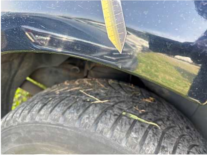
Seitenteil hinten rechts (Steinschlag)
