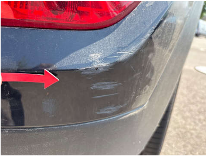
Stoßstange hinten (Kratzer, Lackschaden)
