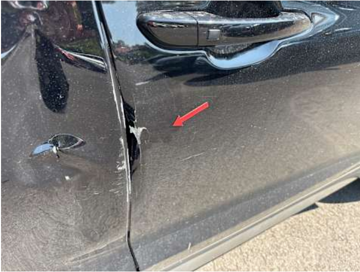
Beifahrertür (Lackschaden, Verformung, Riss/Bruch)
