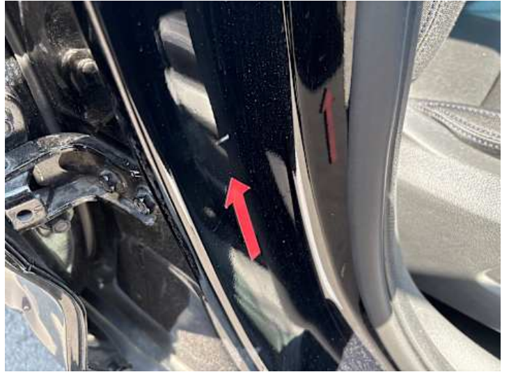
Beifahrertür (Lackschaden, Delle)
