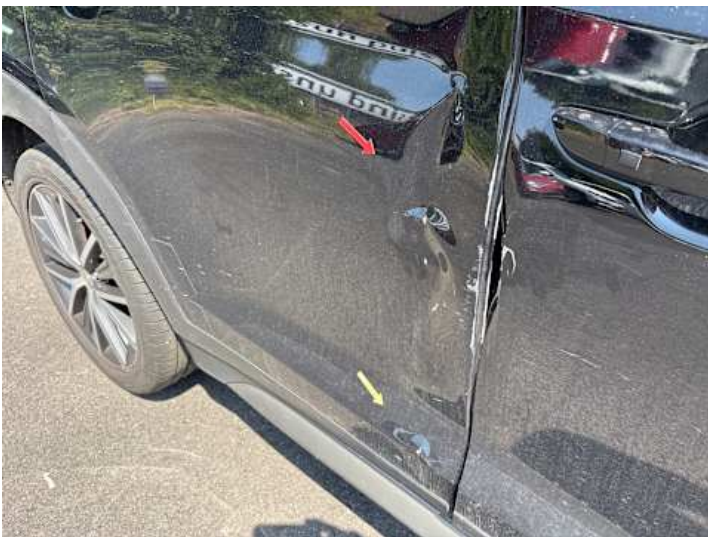
Türe hinten rechts (Lackschaden, Verformung, Riss/Bruch, Kratzer)
