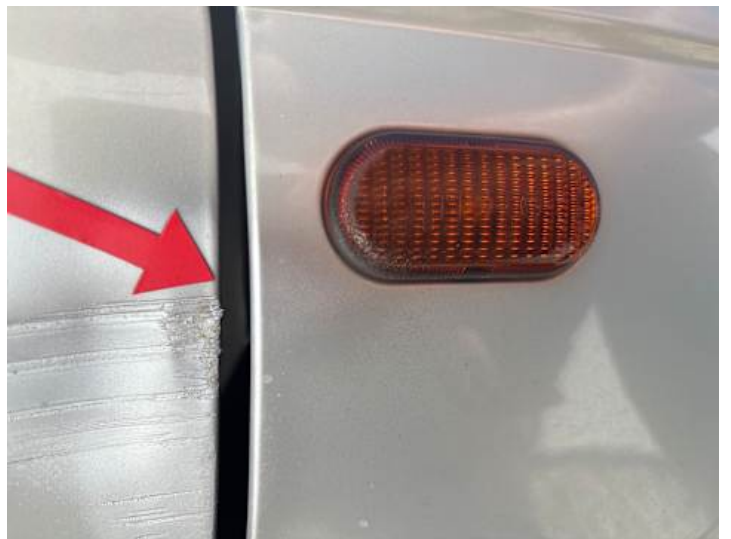
Kotflügel vorne rechts (Lackschaden, Unsachgemäß instand gesetzt)
