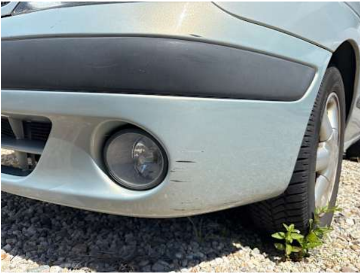
Stoßstange vorne (Lackschaden, Kratzer)
