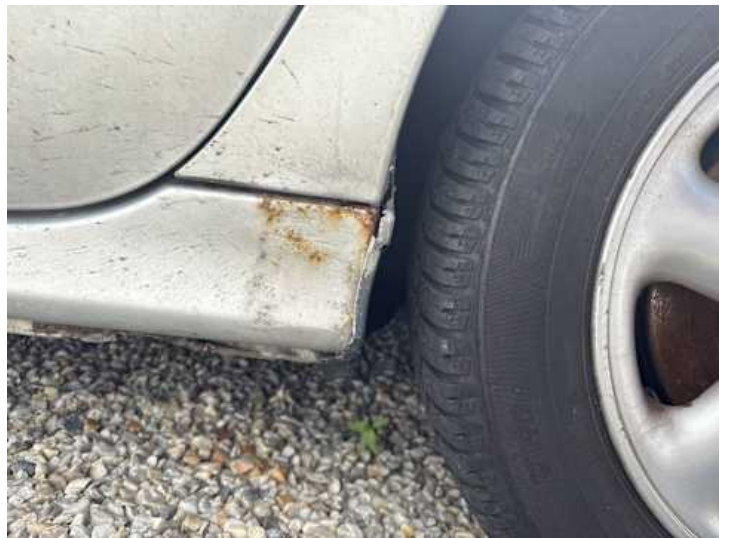
Schweller rechts (Rost)
