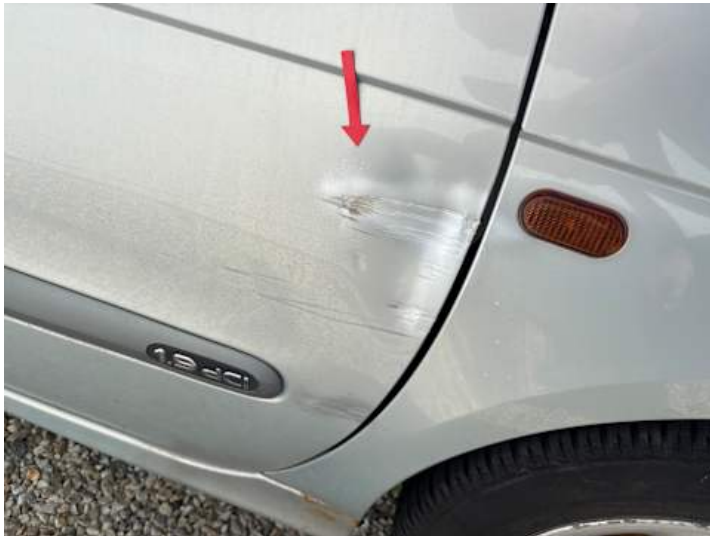
Beifahrtür (Lackschaden, Kratzer, Verformung, Unsachgemäß instand gesetzt)
