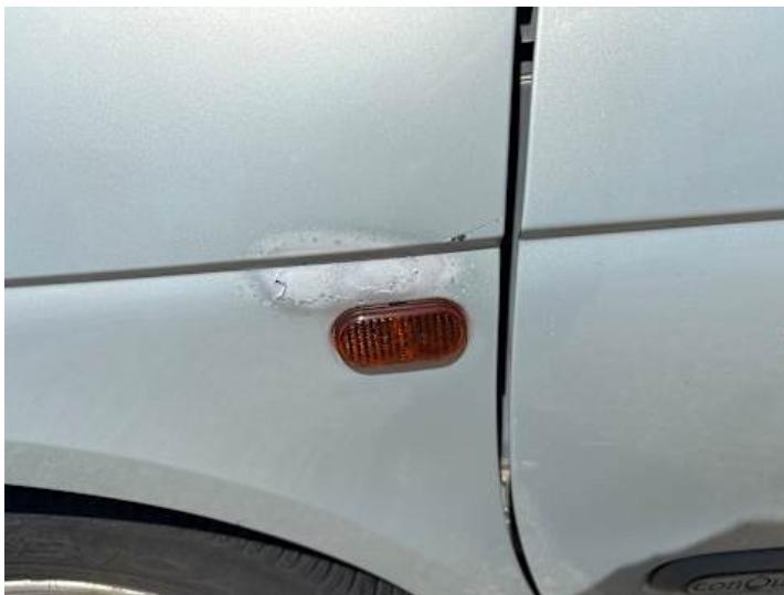
Kotflügel vorne links (Lackschaden, Unsachgemäß instand gesetzt)
