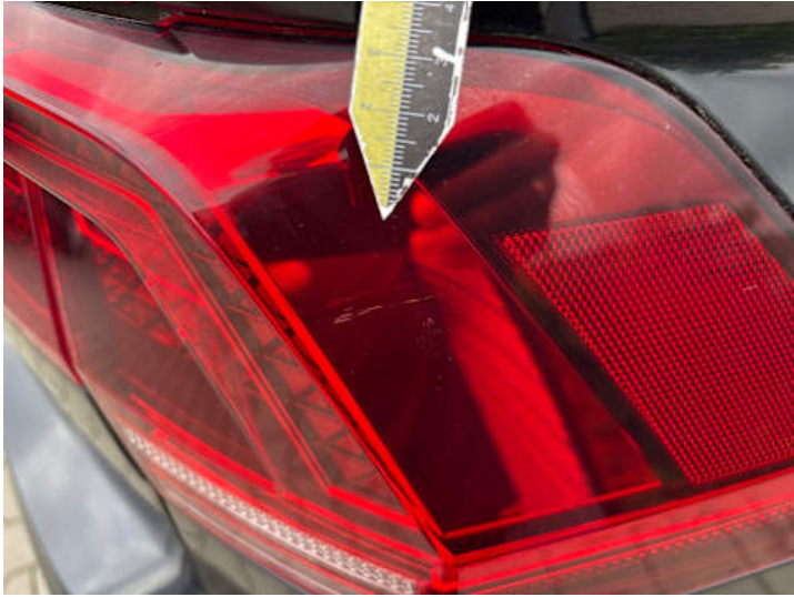
Rücklicht (rechts) (Kratzer)
