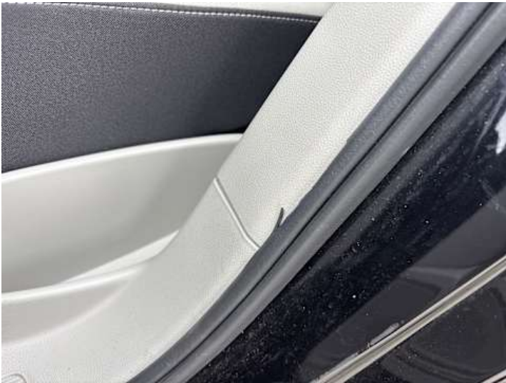
Türe hinten links (Riss/Bruch)
