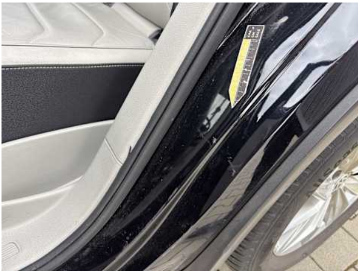
Türe hinten links (Kratzer)
