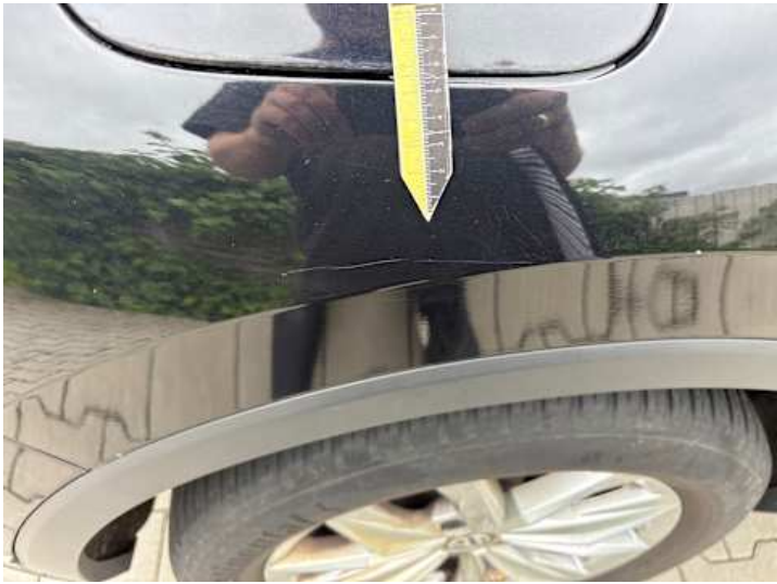
Seitenteil hinten rechts (Kratzer)
