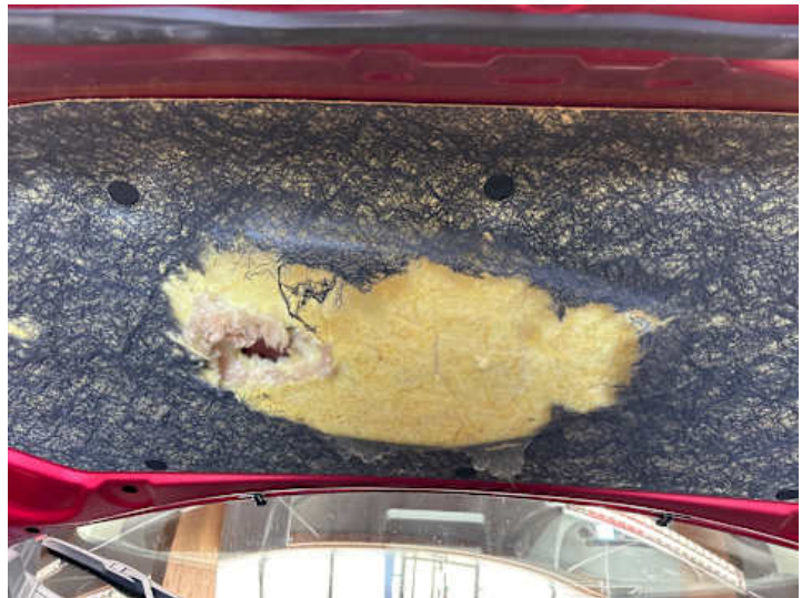
Motorhaube (Anderer Schaden): Marderbiss
