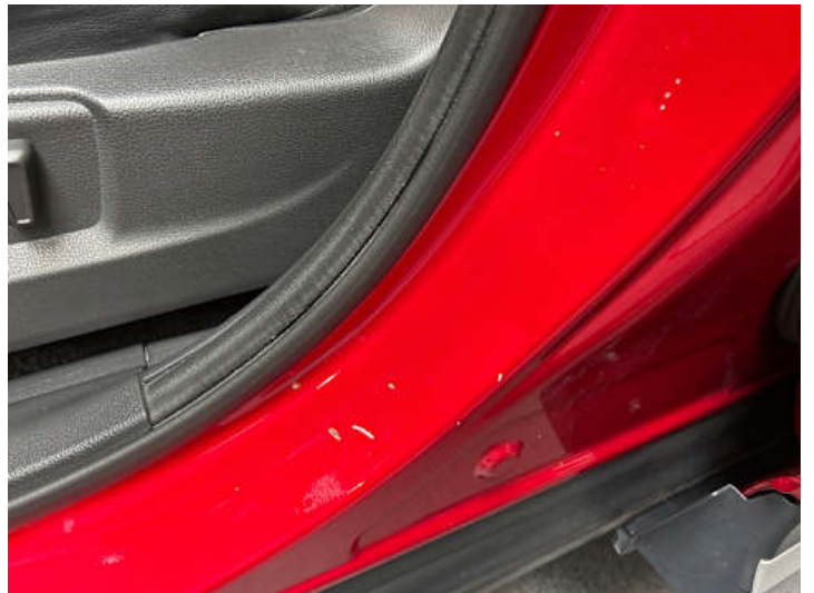
Schweller links (Kratzer)
