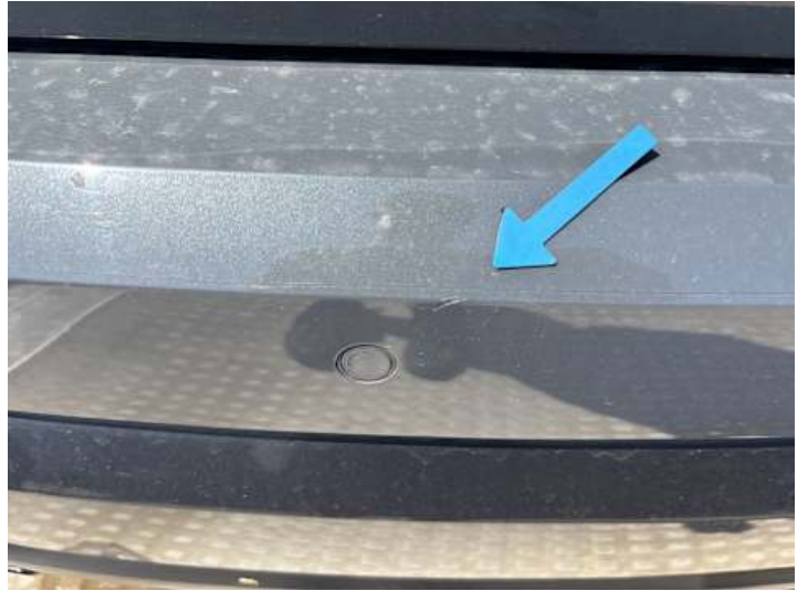
Stoßstange hinten (Lackschaden)
