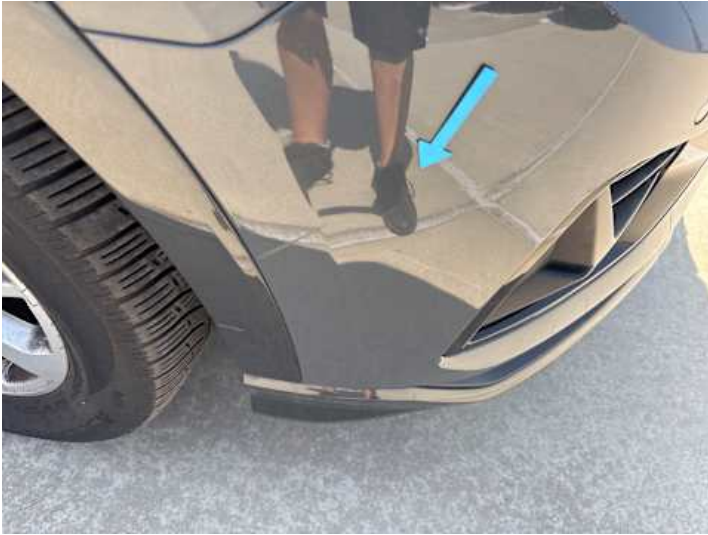
Stoßstange vorne (Kratzer, Unsachgemäß instand gesetzt)
