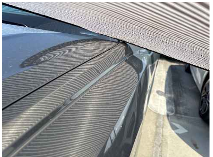
Kotflügel vorne links (Delle)
