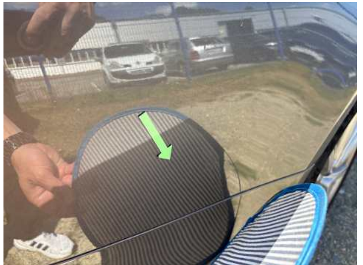
Seitenteil hinten rechts (Delle)
