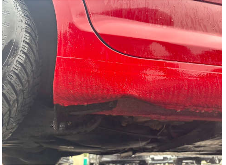
Schweller rechts (Verformung, Lackschaden)
