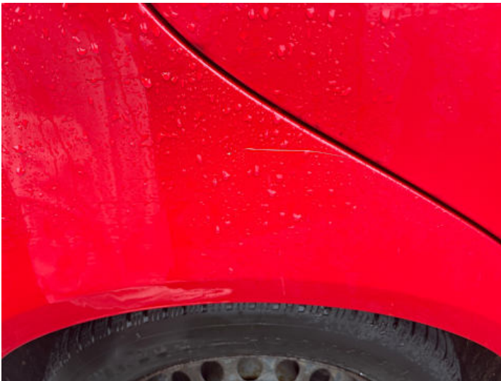
Seitenteil hinten rechts (Kratzer, Lackschaden)
