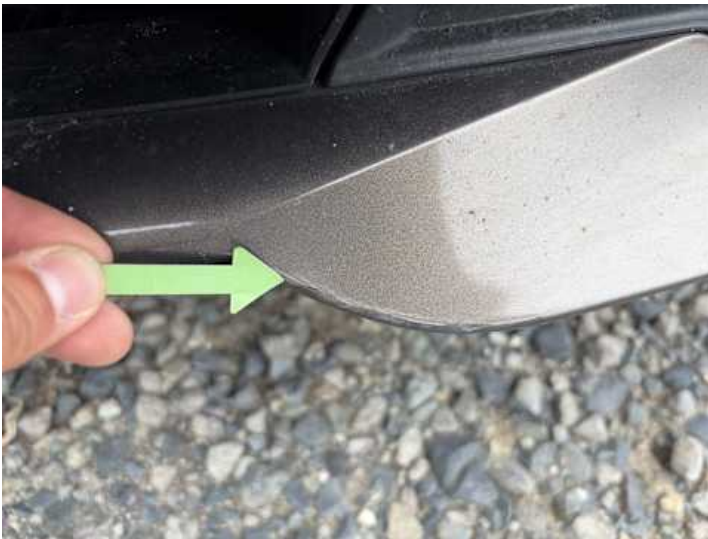
Stoßstange vorne (Verformung)
