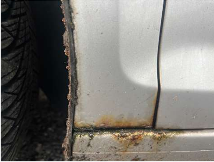
Kotflügel vorne links (Lackschaden, Rost)
