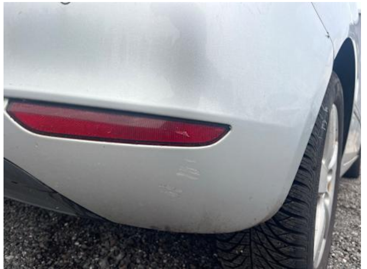
Stoßstange hinten (Kratzer, Lackschaden)
