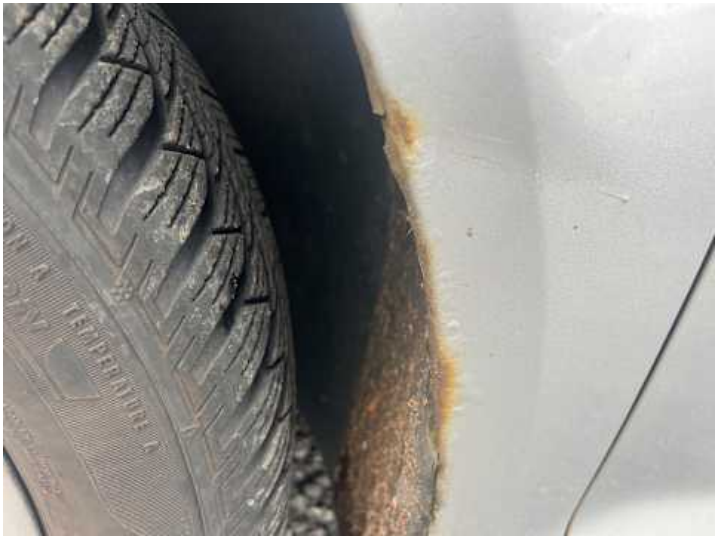
Kotflügel vorne links (Lackschaden, Rost)
