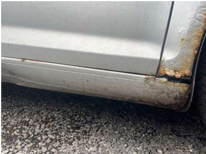
Schweller rechts (Lackschaden, Rost)
