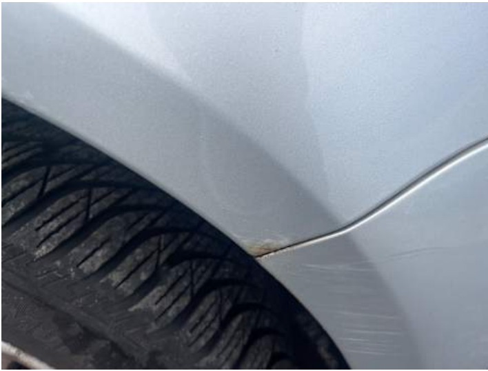
Kotflügel vorne rechts (Kratzer, Lackschaden)
