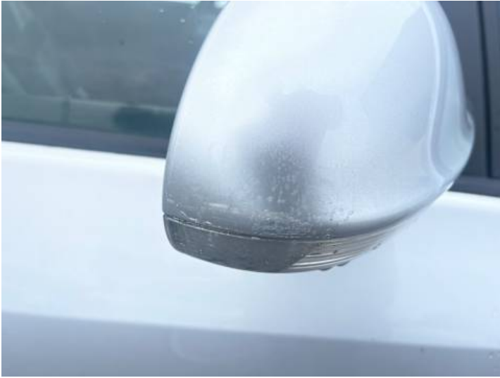
Beifahrertür (Kratzer, Lackschaden)
