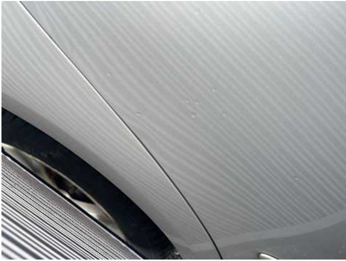
Türe hinten rechts (Verformung)
