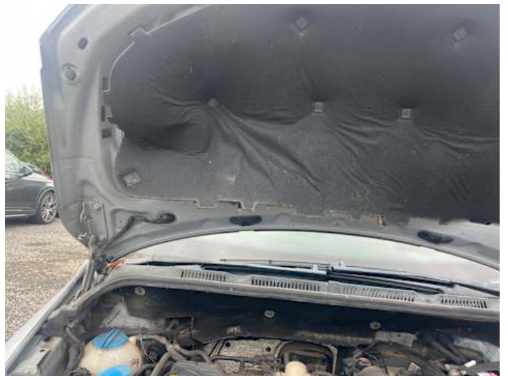
Motorhaube (Anderer Schaden): Dämmmatte beschädigt
