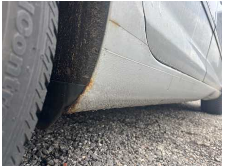
Schweller rechts (Lackschaden, Rost)
