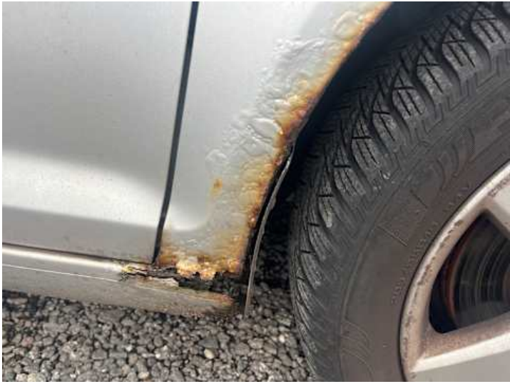
Kotflügel vorne rechts (Lackschaden, Rost)
