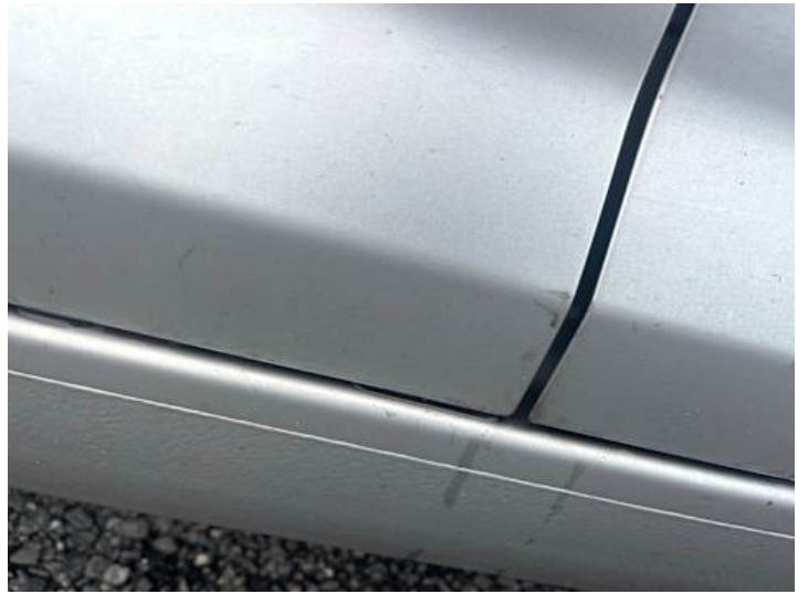
Türe hinten rechts (Kratzer, Lackschaden)
