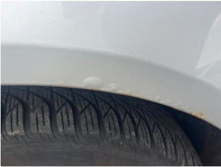
Kotflügel vorne links (Lackschaden, Rost)
