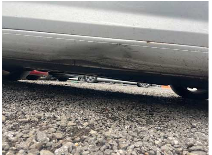
Schweller rechts (Verformung)
