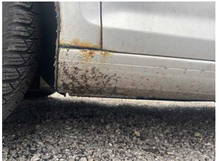
Schweller links (Lackschaden, Kratzer)
