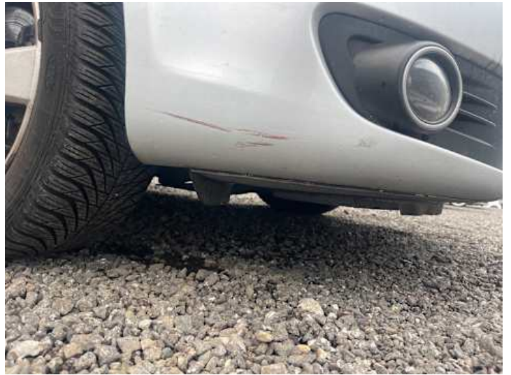
Stoßstange vorne (Lackschaden, Kratzer)
