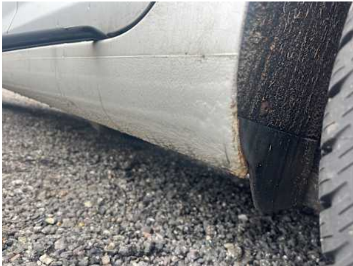
Schweller links (Lackschaden, Kratzer)
