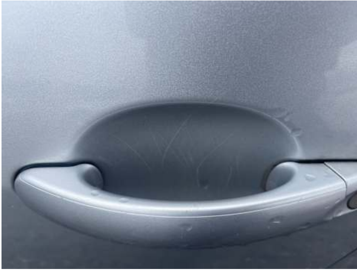
Fahrtür (Kratzer, Lackschaden)
