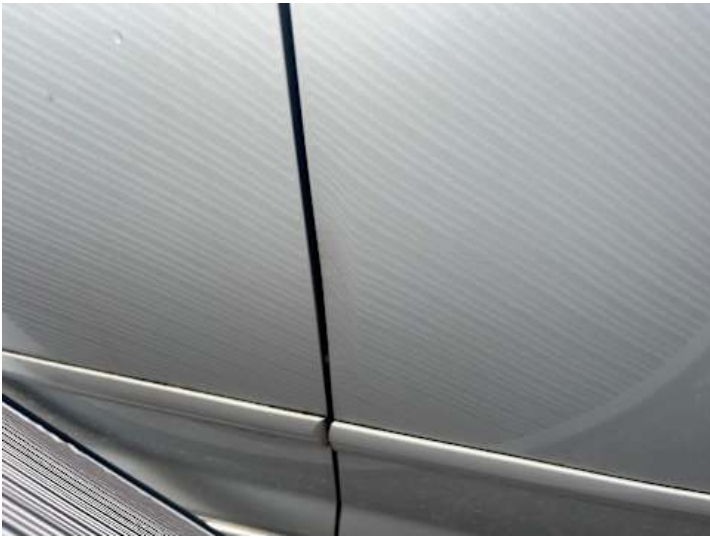
Beifahrertür (Verformung, Anderer Schaden): Schwergängig
