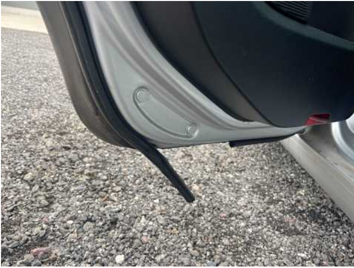
Türe hinten links (Anderer Schaden): Türdichtung beschädigt
