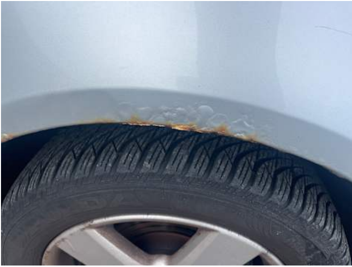
Kotflügel vorne rechts (Lackschaden, Rost)
