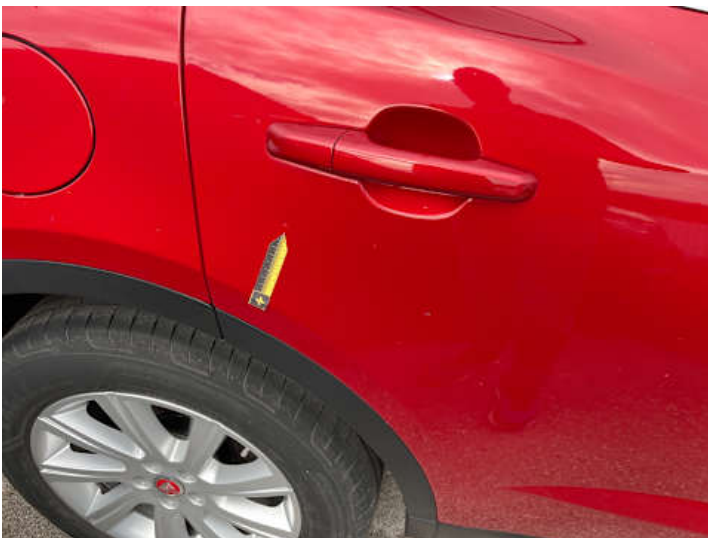
Türe hinten rechts (Delle, Kratzer)
